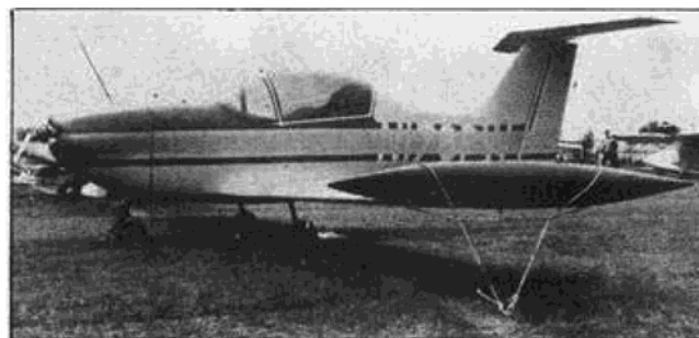
Τό Polliwagon, συνθέτου κατασκευής (πλαστικό + ξύλο)
