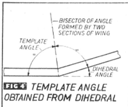
**FIG 4** TEMPLATE ANGLE OBTAINED FROM DIHEDRAL
