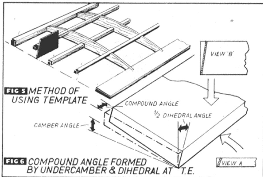
**FIG 6** COMPOUND ANGLE FORMED BY UNDERCAMBER & DIHEDRAL AT T.E.
