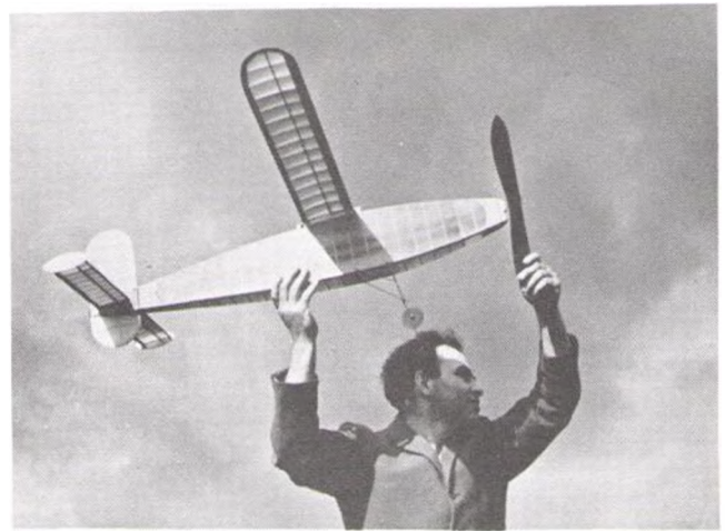
Lennart Skoog, Nimbus, hann se att hans Ellilä-konstruktion verkligen kunde flyga innan den totalkvaddades. OBS De två gummimotorerna. Två kuggjul i aktern överför kraften från den undre gummimotorn till den övre.
