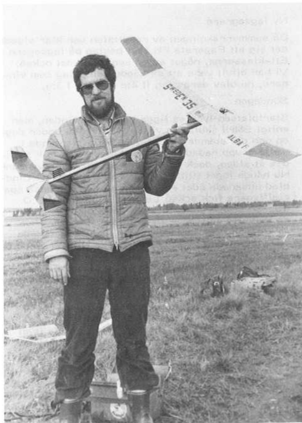
Jan Zetterdahl med en Wakefield-inspirerad C:1A. Obs! Vingen med geodetiska spryglar för bättre styrka.
