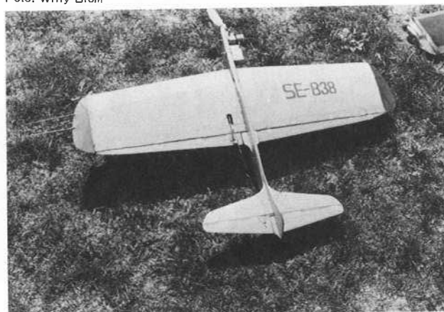
Hollners modifierade Shark 15 i närbild. Lägga märke till den pilformade vingen som ger förbättrade flygegenskaper. Foto: Willy Blom
