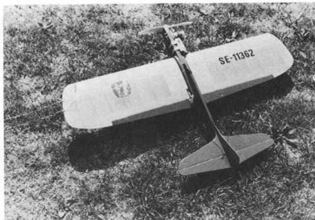
Thomas Petterssons välbyggda modell, tyvärr något tung. Lägga märke till förstärkningarna vid vingen på båda sidor av profil-kroppen. Foto: Willy Blom
