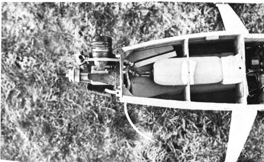
Tankutrymmet. Observera skyddande skumplast runt tanken samt mot spantet.
