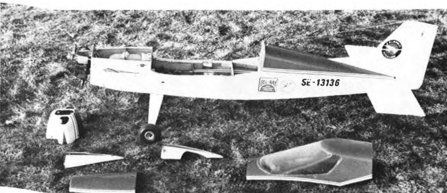
Tankutrymmet. Observera skyddande skumplast runt tanken samt mot spantet.
