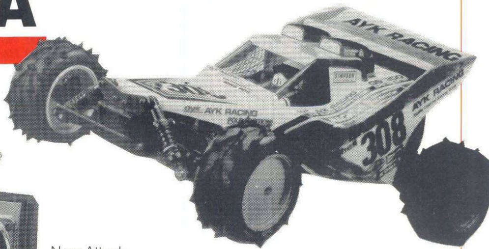
AYK Racing RADIANT Buggy. Skala 1:10. 4WD kuldiff. Drivning med lättviktskedja. Säljs komplett med motor 600 S.
