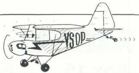
Här har Cuben utrustats med en tvåcylindrig Tartan-motor
