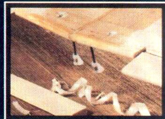
Vingframkanter i furu hindrar gummisnoddar att skära in och skada övriga ytor i balsa - ännu ett plus med Great Planes-byggsatserna.
