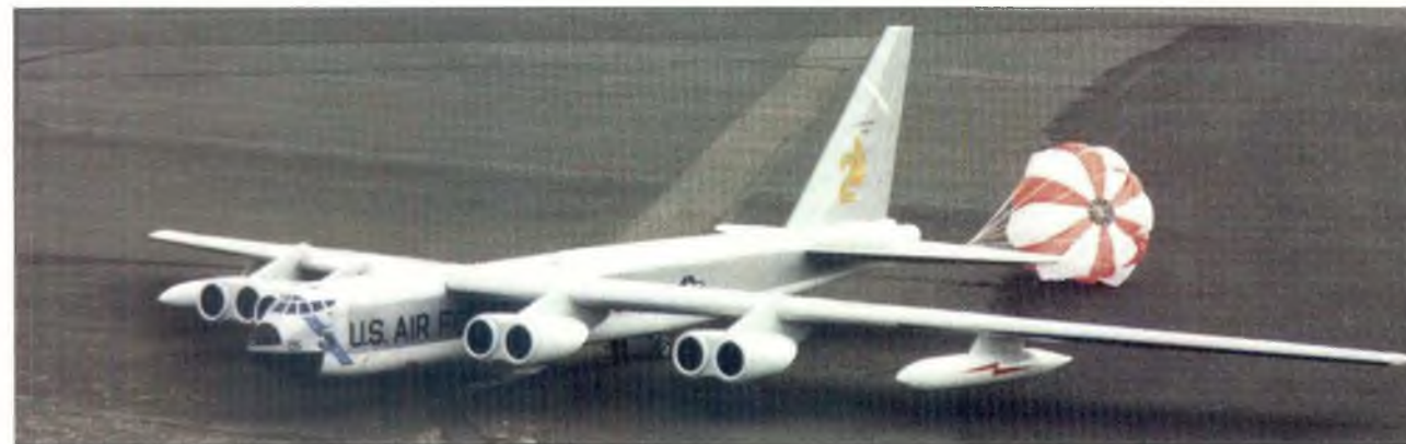
En maffig B-52 — även den ett BPKF-bygge med eldrift! Nära 3 meters spännvidd och 7 kilos vikt.
