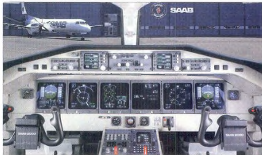
Cockpit i SAAB 2000 med lättavlästa displayer, där det mesta presenteras – motorvärden, höjd, kurs, fart, vind. I två av displayerna visas också de inknappade flygfyarna, där även flygplanets radarbild visas. I detta syseende är SAAB 2000 bland de främsta i världen!
