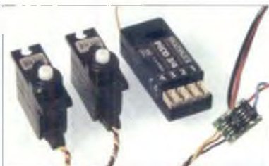
Servon, mottagare, fartreglage = cirka 25 gram!
