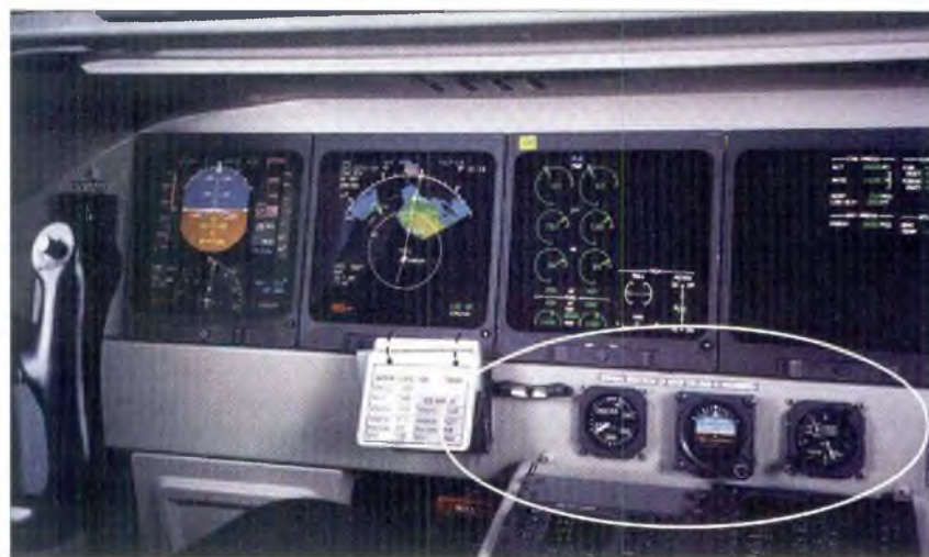
Inringade "kulan", hastighetsmätare, girindikator & höjdmätare – instrument av den gamla "hederliga" typen att förlita sig på, om displayerna av någon anledning skulle falera eller släckas ut.
