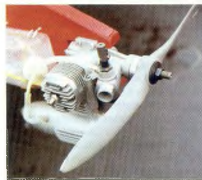
Tanken ska få plats bakom motorn för säker bränsleförsörjning.
