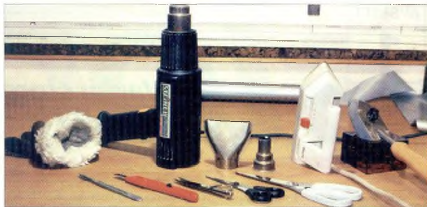
Sussis "trivsel"-verktyg, när hon klär med Solartex. Ett litet resestrykjärn med låg temp för större, släta ytor, ett mindre hobbyjärn med högre temp för mindre ytor. En varmluftspistol ingår också i utrustningen.
