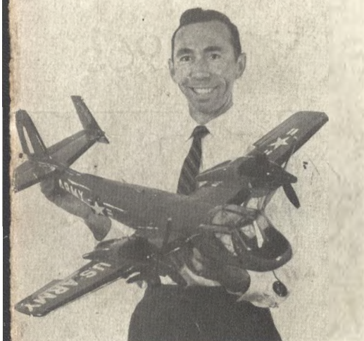
▲ Člen subkomise FAI McGuinn s maketou torpedového letadla „Mohawk“. Model má ovládnání otáček motorů (2 × Zeiss 2,5 cm 3 ), světel, přistávacích klapek, pumovnice a podvozku
