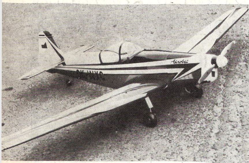
▲ Tak vypadá RC maketa Z 526 AS konstrukce M. Hestera, vítěze I. mezinárodní soutěže v Brémách. Model o rozpětí 72" (asi 1.830 mm) vyrábí firma SIG. Tento kus byl sestaven kolektivem LMK Krnov
