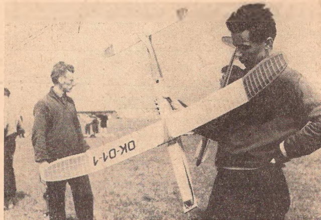
XL-58B v roce 1963 měl již upravenou výškovku a částečně i křídlo (bez tuhého potahu náběžné části), ale ještě 50g gumový svazek, tudíž vza du tlustší trup. Křídlo bylo uloženo na bradélkách
