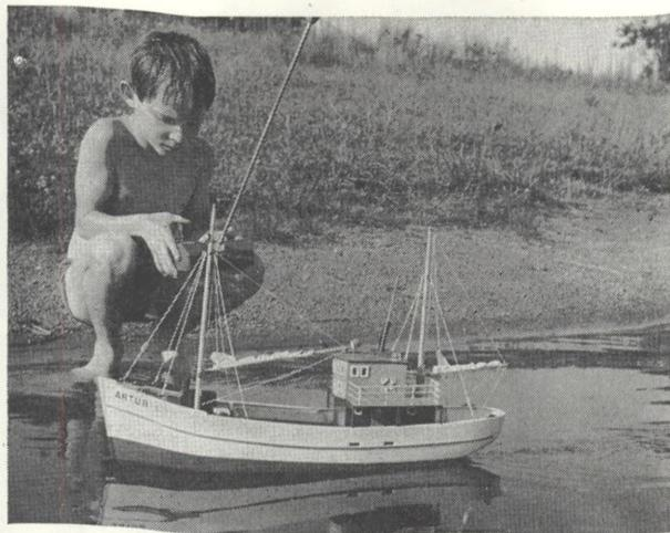
Potěšte se v zimní slotě vzpomínkou na leto s pohledem na hezkou loďku. Postavil ji z nové stavebnice Igla ing. J. Pavláček z Prahy. ARTUR je řízen RC soupravou W-43 ovládající smysl jízdy (3 stupně) a směr. K pohonu stačí elektromotor Igla 4,5 V s dvoulistou vrtuli o Ø 38 mm a 6 akumulátorů NiCd 900
