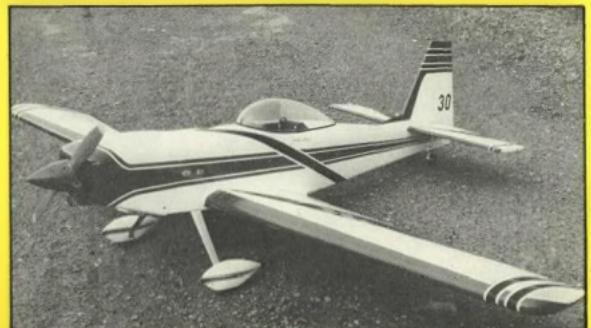
► Ivo Klívanek ze Žďáru nad Sázavou uspěl i v kategorii F1B s RC polomakací akrobatického letounu Spinke Akromaster o rozpětí 1938 mm a hmotnosti 4600 g. Model je poháněn motorem HB-61, soupravou Kraft jsou ovědeny směrovka, vyskovka, křídélka a otáčky motora
