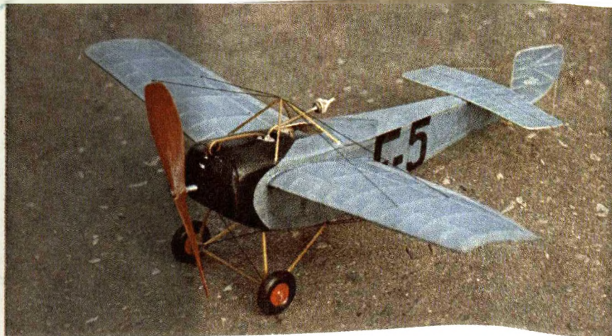
▲ Polomaketa Ponnier o rozpětí 365 mm P. Nováka z Broumova je poháněna motorem na \text{CO}_2 o zdvihovém objemu 0,033 \text{ cm}^3 vlastní konstrukce
