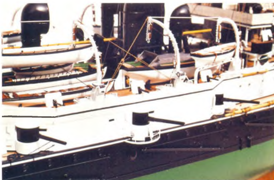
Střed loďe s 15 cm děly uloženými v pancéřových kasematech. Na manévrové palubě jsou 47 mm kanony a otočné jeřáby pro manipulaci se zde uloženými čluny
