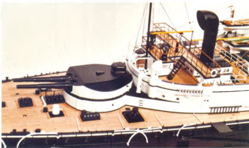
Zadní 24cm dělová věž navazující na nástavbu se zadním můstkem. Pod ní je zadní pancéřové velitelské stanoviště. Veškeré člunové jeřáby, padací schůdky, zábradlí, tyče protislunečních plachet, žerdě a větráky jsou odstrojené a uloženy jako při bojovém poplachu
