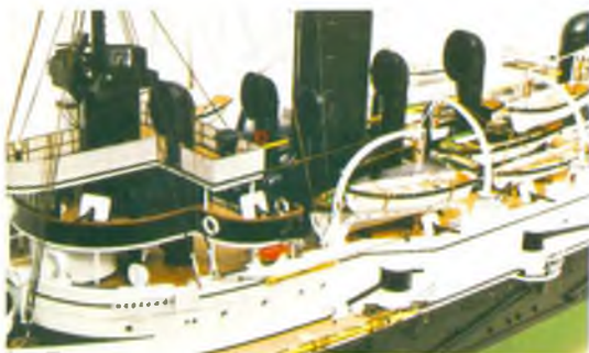
Levobok předních nástaveb. Na velitelském můstku a bojovém marsu jsou 47 mm rychlopalné kanony, pod můstkem je vidět bíle natřená oválná pancéřová velitelská věž
