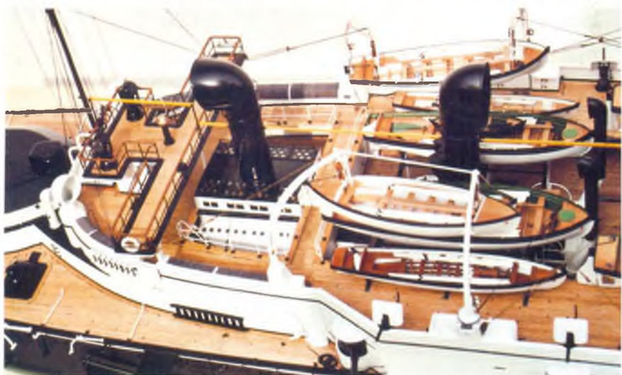
Pohled shora na manévrovou palubu s uloženými čluny. Na jeřábech je na pravoboku zavěšen záchranný kotr, na levoboku normální kotr. Na světlicích strojeven jsou dva robustní větráky (přední nasávající a zadní odvětrávající vzduch)
