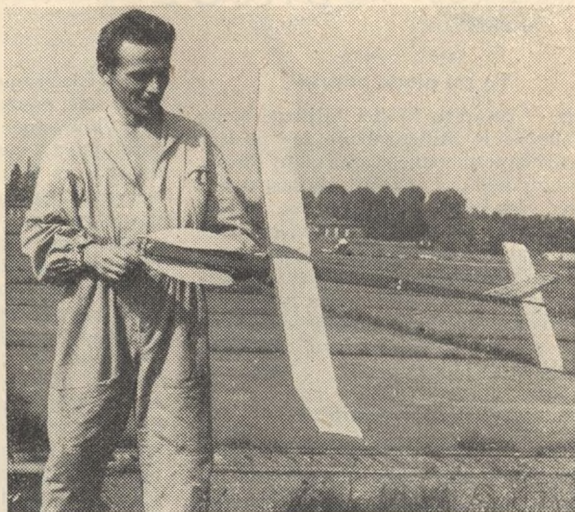
Obr. 4. Vicemistr světa v kategorii Wakefield, J. Kosinski z Varšavy, s úspěšným modelem „Kř-61“. Technická data modelu: rozpětí 1260, délka 1090 mm; plocha křídla 15,1, výškovky 3,68 dm 2 ; vrtule 580/720; svazek ze 14 vláken Pirelli 1×6
