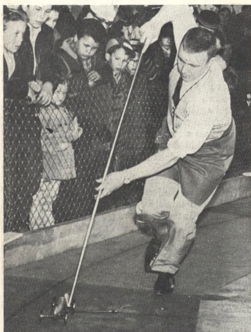
▲ Švédský modelář Lennart Helander dosahuje s motorem Dooling 5 s magnetem 187, s detonační „dvaapůlkou“ 168,8 km/h, s motorem 2,5 cm 3 vlastní konstrukce 171 km/h
