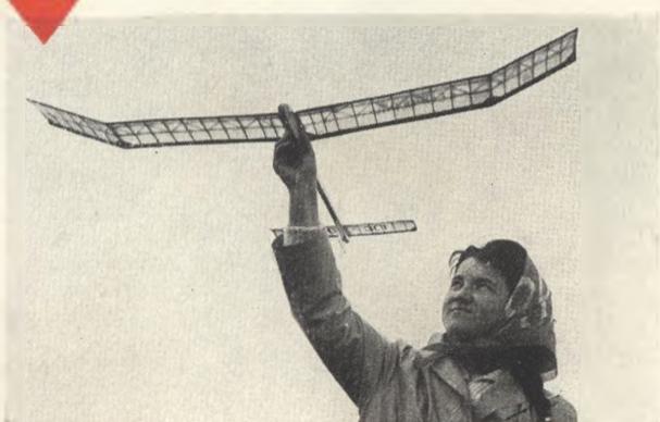
Upoutaná maketa stíhačky LA 5 FN je prací L. Houhy z LMK J. Hradec. Údaje: měřítko 1:5,3, převážně tuzemský materiál, motor MVVS 5,6 AL, zatahovací podvozek a ovládání otáček, rychlost 85 km/h
