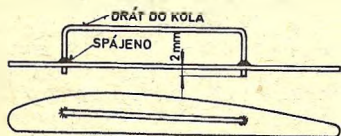
OBR. 2. Šablona na obkreslování a vyřezávání žebér z ocelového plechu o tloušťce asi 1,5 mm; oproti přesnému tvaru žebra má přídavek na opracování asi 0,5 mm
