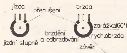
Obr. 1 Úprava potenciometrů (pohled ze strany hřídele)
