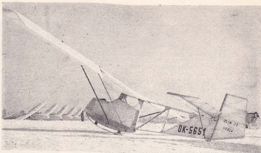
Také Z-23 se dočkal modernizace – několik kusů mělo pilotní gondolu
