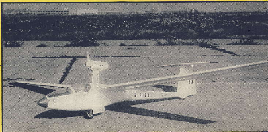
▲ Jaroslav Novák z Prahy opatřil maketu VSO 10 pomocným motorem TONO 3,5 RC, ovládaným třetím servem
