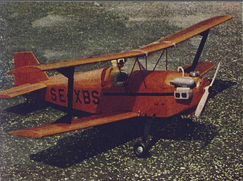
▲ Vojtěch Ambros z Brna létá s maketou BA-4B o rozpětí 970 mm a hmotnosti 1100 g, poháněnou motorem OS MAX 2,5 RC. Rádiem jsou řízeny směrovka, výškovka a otáčky motoru
