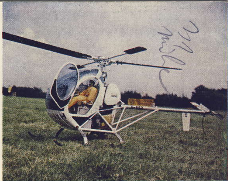
▲ Maketu vrtulníku Hughes 300 zcela amatérsky zhotovil Rakušan Leopold Köppl z Halleinu za 800 hodin – včetně motoru o zdvihovém objemu 8 cm 3 . Model o hmotnosti 3900 g absolvoval do října loňského roku 17 letových hodin, během nichž byla úspěšně vyzkoušena i autorotace
