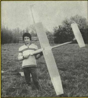
▲ Větroň kategorie RC V1 si sám navrhl a zhodovil Stanislav Jírák z modelářského kroužku při Domě pionýrů v Pardubicích. Model postavený až na laminovanou kabiničku klasickým způsobem má křídlo opatřené turbulátorem. Je ovládán sovětskou RC soupravou Pilot 2 a vyznačuje se velmi dobrými letovými vlastnostmi
