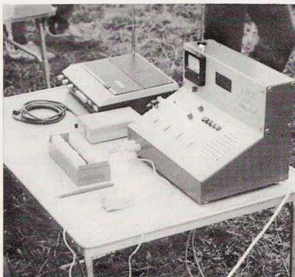
◀ Hezké fidici stanoviště používají členové LMK Tesla Přelouč. Kontrolní přijímač, nahrávání na magnetofon, digitální měření času. Nechybí ani mikrofon se zesilovačem pro informativní hlášení
