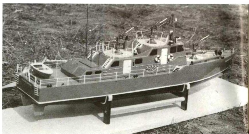
▲ Model požární lodi Düsseldorf postavil J. Šolc z Neratovic. Je poháněna amatérsky zhotoveným elektromotorem PEŠO, ovládána je jízda vpřed a vzad, funkční vodní dělo dostříkne do vzdálenosti asi šest metrů
