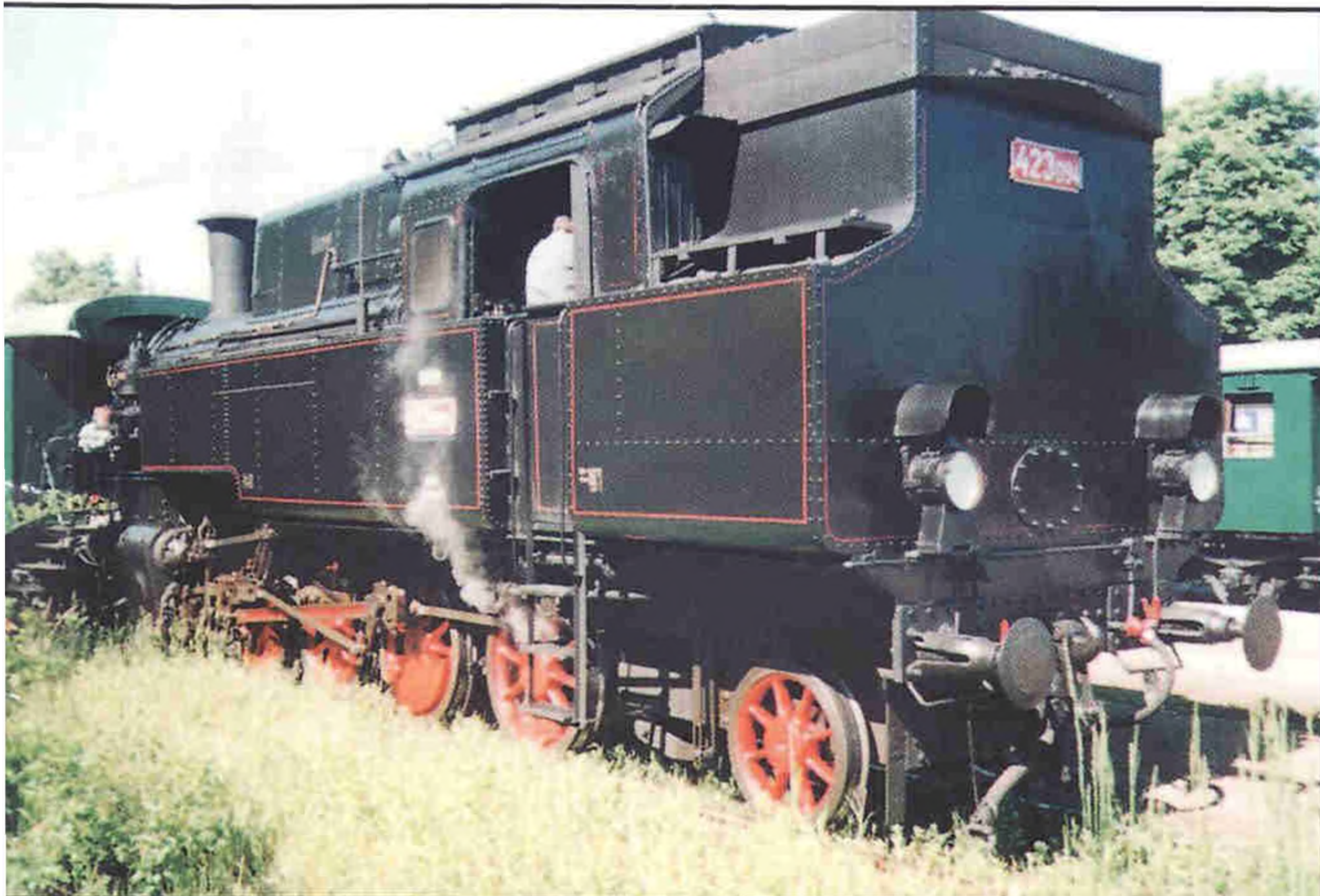
▲ Parní tendrová lokomotiva 423.094. Jde o výrobek Lokomotivky ČKD z roku 1928 s přezdívkou „Velký bejček“. Dodnes jsou v provozu při příležitostných akcích tři tyto stroje.
