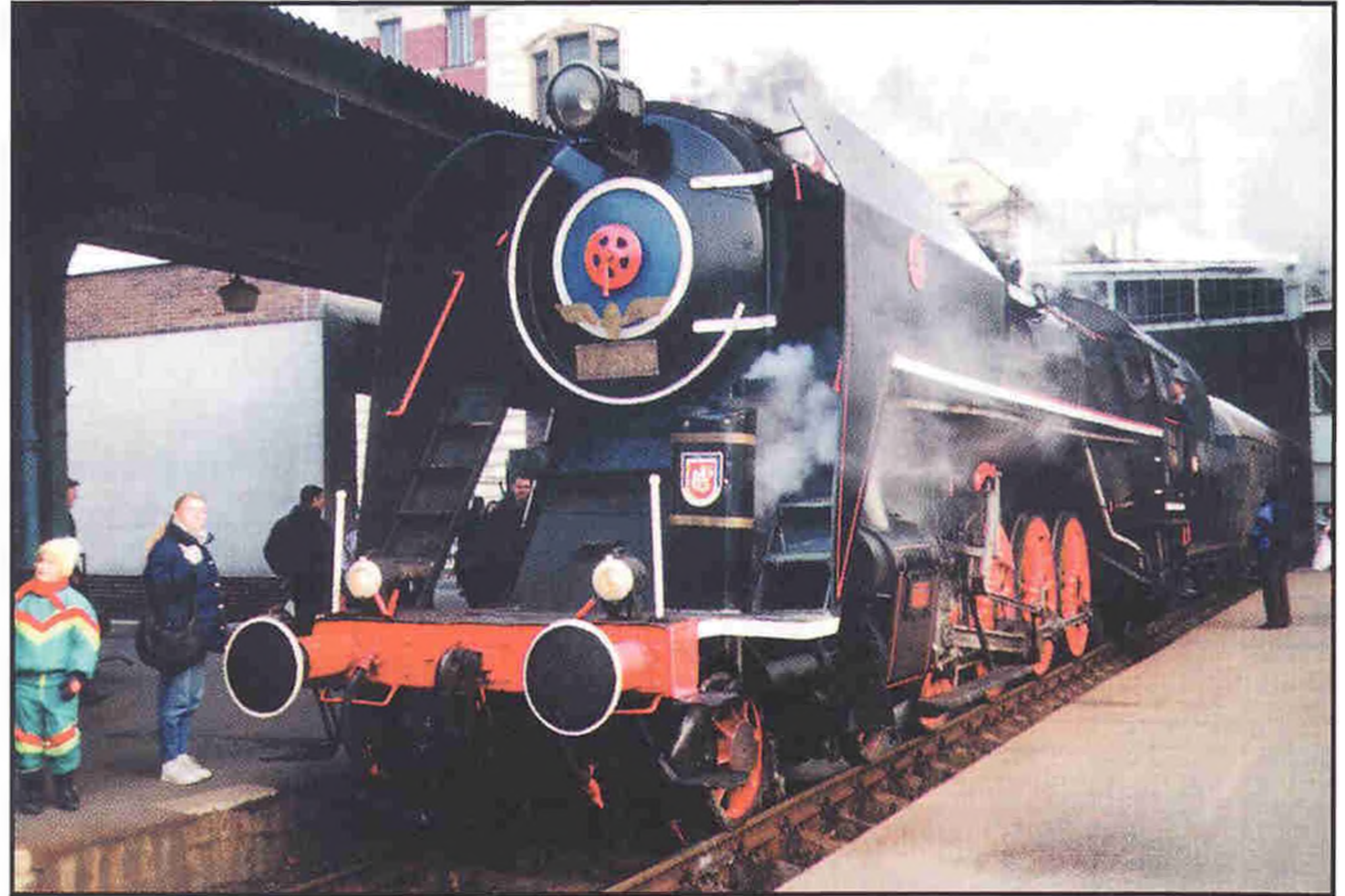
▲ Parní lokomotiva 475.179 z roku 1950. Této krásné lokomotivě ze Škody Plzeň s uspořádáním náprav 2D1 a výkonem 1800 k (1325 kW) se přezdívá pro její ušlechtilý vzhled „Šlechtična“.
