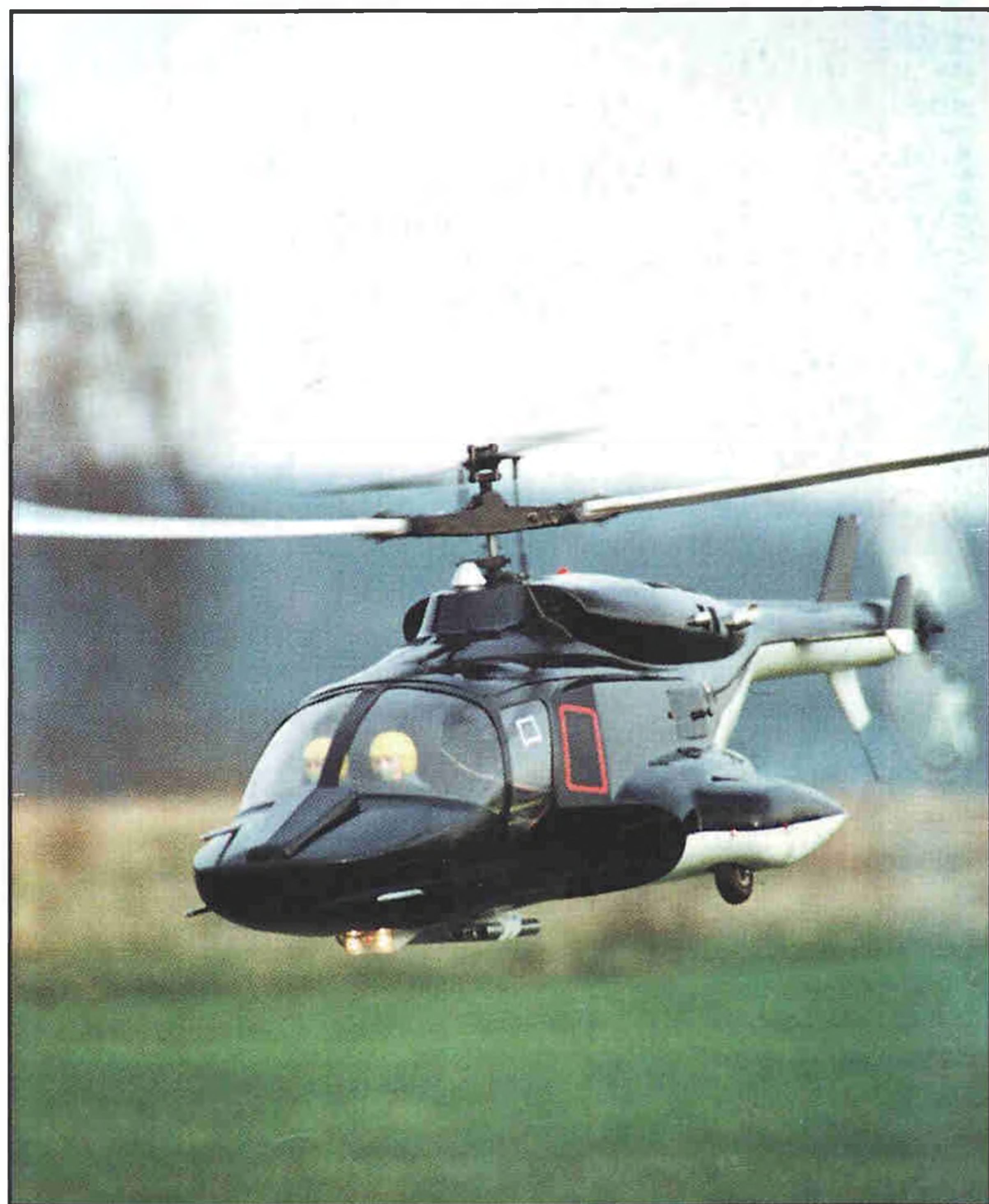
▲ Plně funkční RC polomaketa vrtulníku AIRWOLF. Skelet z epoxidové pryskyřice, okna zasklená fólií durofol, celková délka trupu 1350 mm, průměr rotoru 1500 mm, hmotnost 6,5 kg.
