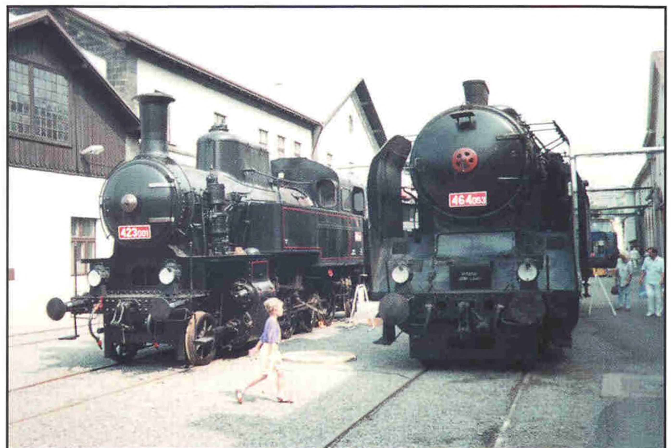
▲ Dvě „páry“ při výstavě na Masarykově nádraží v Praze. Vlevo „tendrovka“ 423.001 (1924) „Velký bejček“ – uspořádání náprav 1 D 1, vpravo tendrovka 464.053 (1935) „Ušatá“ – uspořádání náprav 2 D 2.
