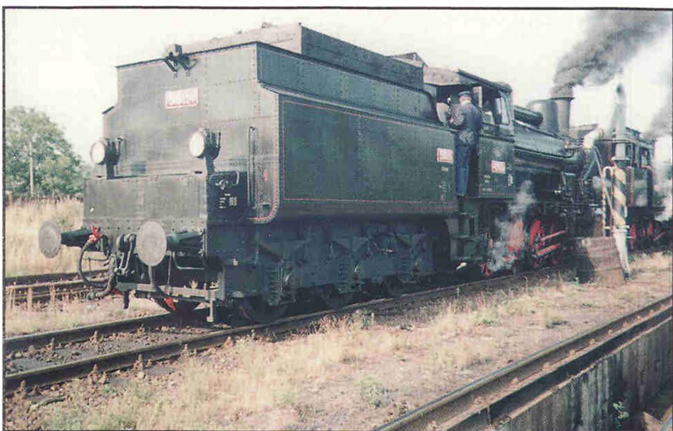
▼ „Čtyřkolák“ se právě chystá doplnit vodní zásobu v tendru z vodního jeřábu. Parní lokomotiva 434.2186 z roku 1916 na nádraží v Hostivících.
