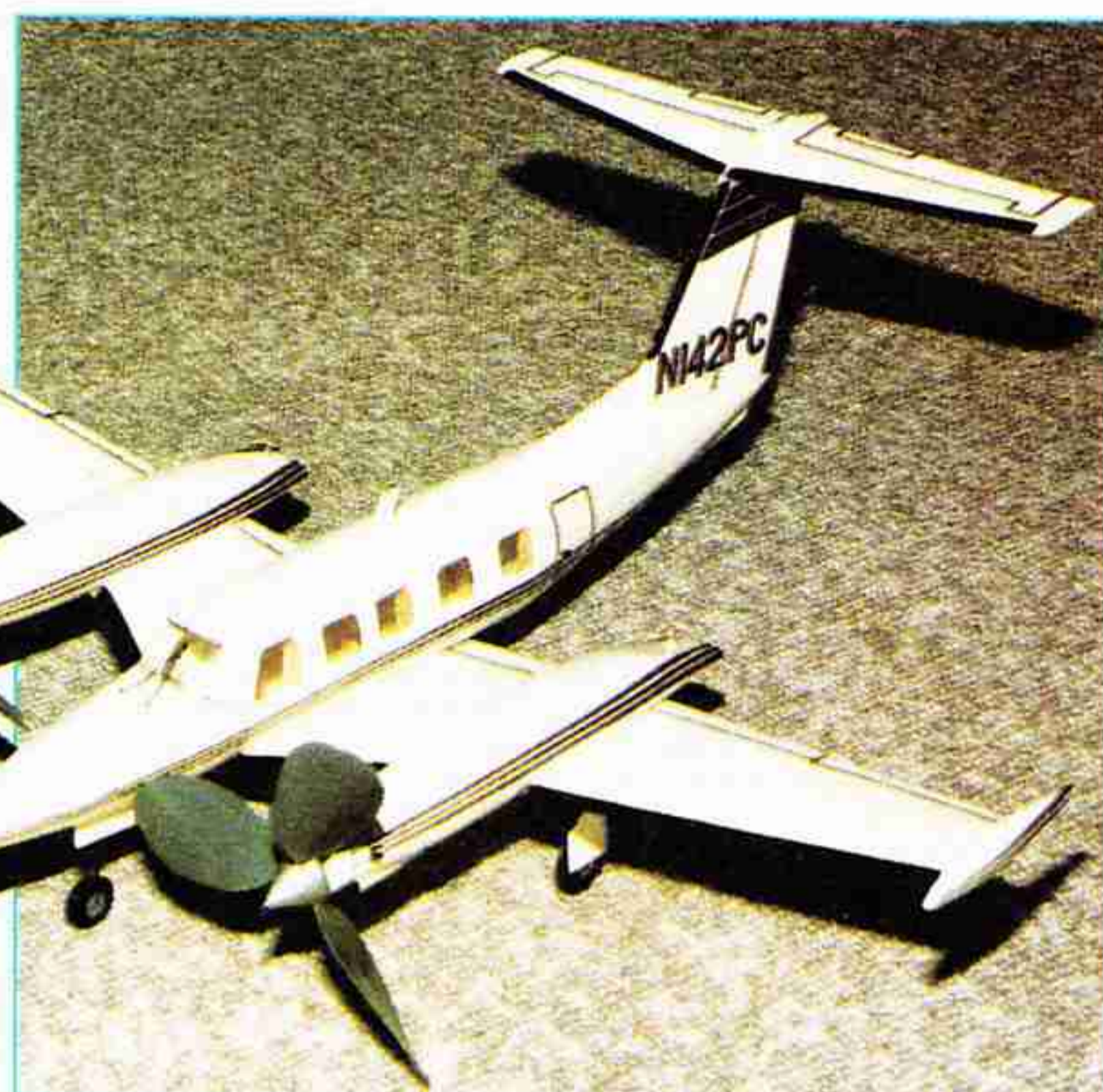
Třílisté vrtule dvumotoráku Piper Cheyenne III mají souhlasný smysl otáčení, rozdílné úhly stoupání jejich listů ovlivňují stálost „levé zatáčky“.
