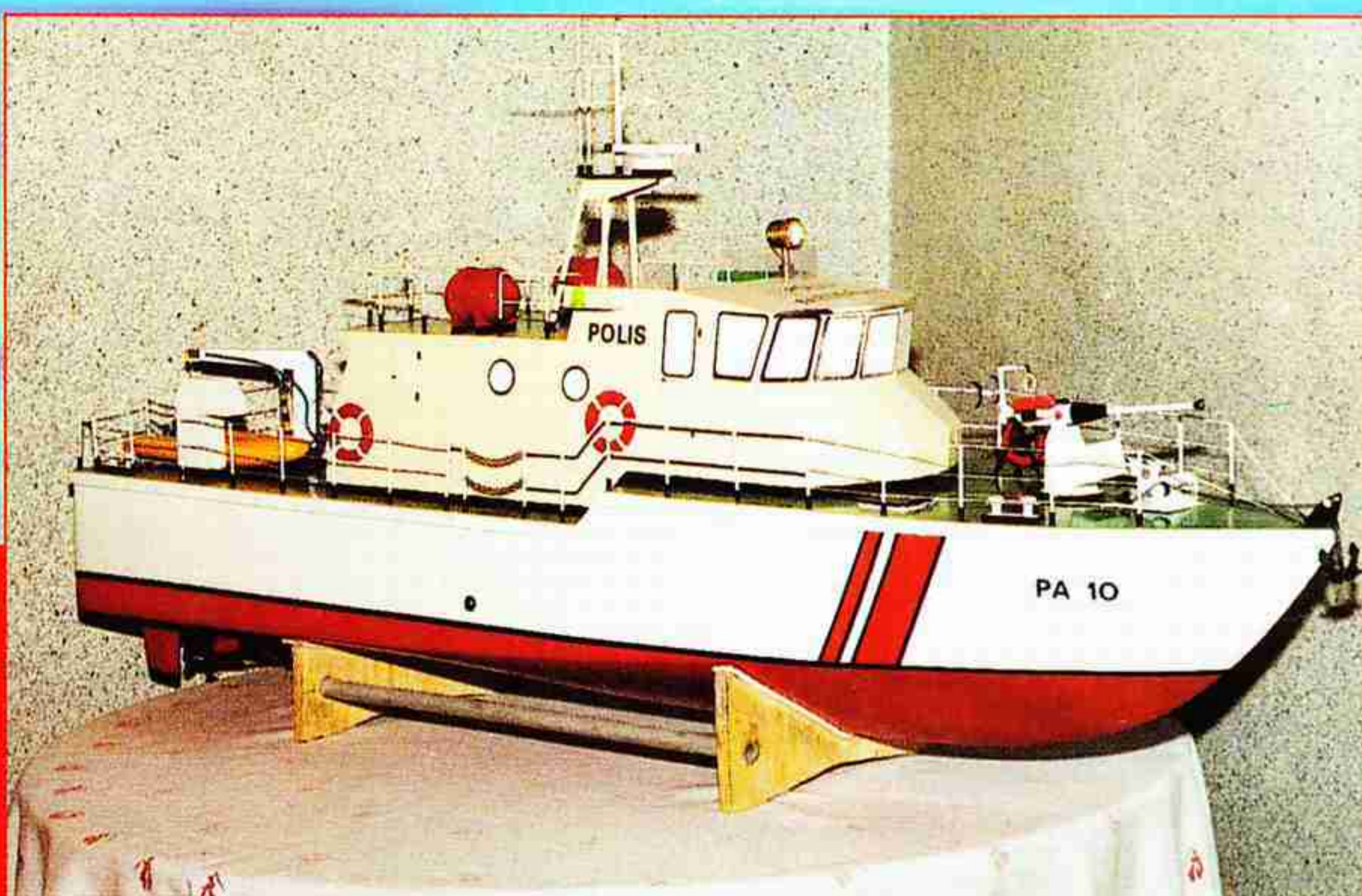
Policejní člun PA 10 pobřežní nizozemské policie postavil Josef Darvaš z LMK Dvůr Králové nad Labem. Člun má laminátový trup, nástavby jsou z kuprextitu tl. 0,4 mm. Detaily jsou zhotoveny z balzy, plast. hmoty, kovu atd. Policejní loď je poháněna dvěma elektromotory (12 V / 8 W). RC souprava ovládá motor (jízda vpřed, vzad), kormidlo a čerpadlo na chlazení motorů.
