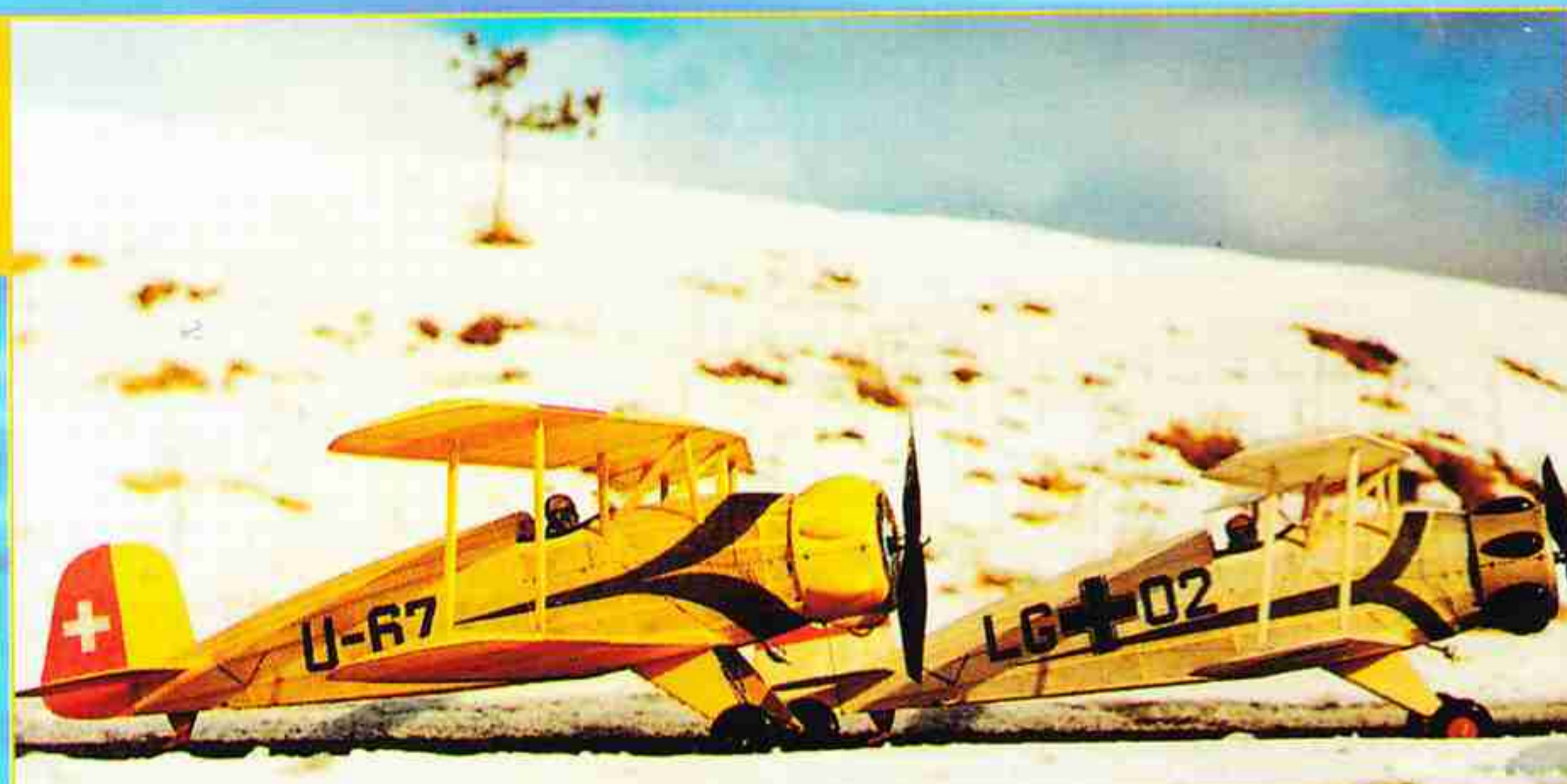
„Zimní“ letka maket Bů 133 Jungmeister Zdeňka Rašky z Frenštátu pod Radhoštěm. Rozpětí maket 650 mm, hmotnost 88 g, pohon motorem Modela CO 2 .
