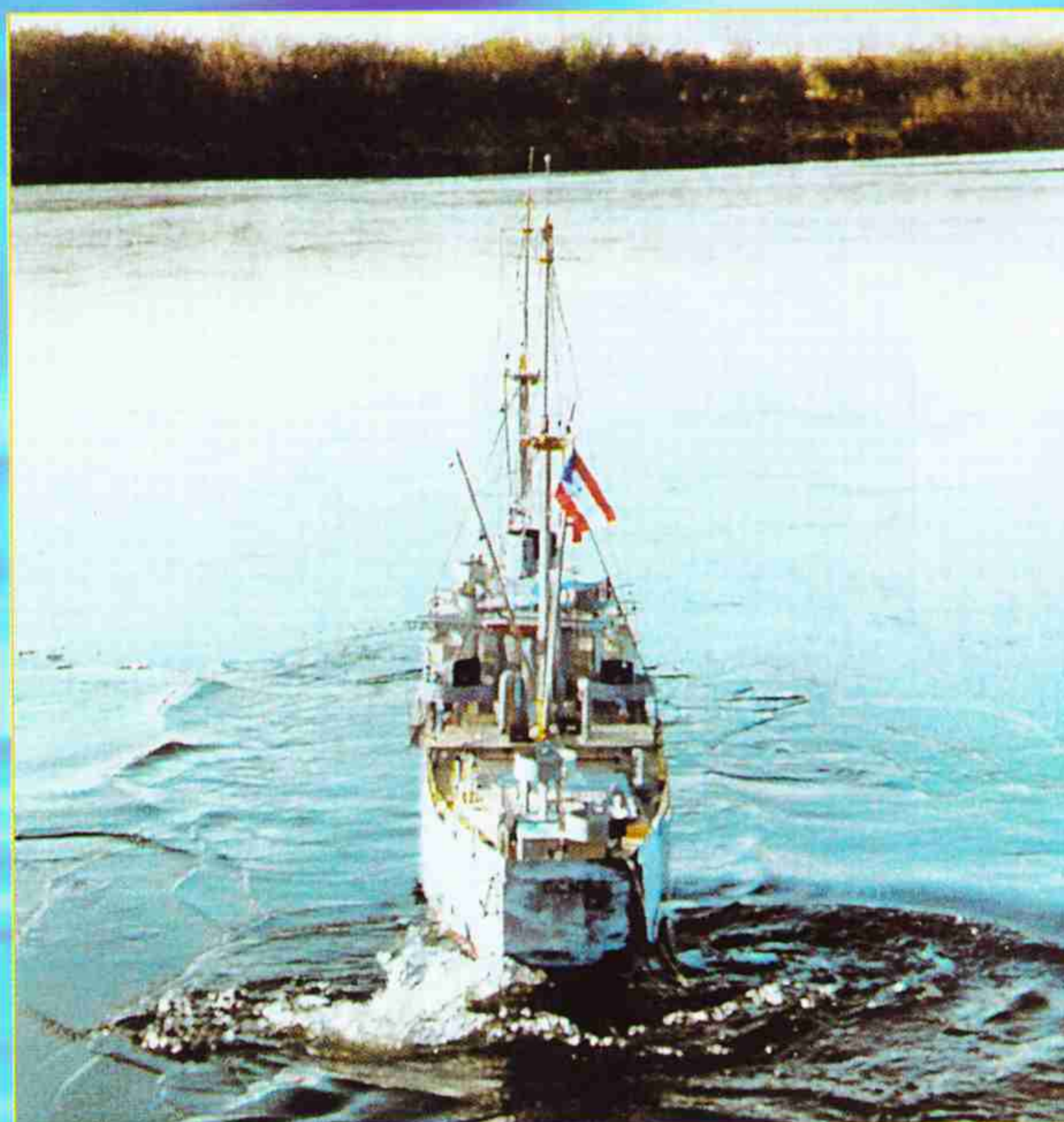
Polomaketa korzárského křižníku od Pavla Zlínského z Loštic. Křižník (délka 2380 mm) poháněný elektromotorem Johnson proráží ledovou tříšť na hladině.
