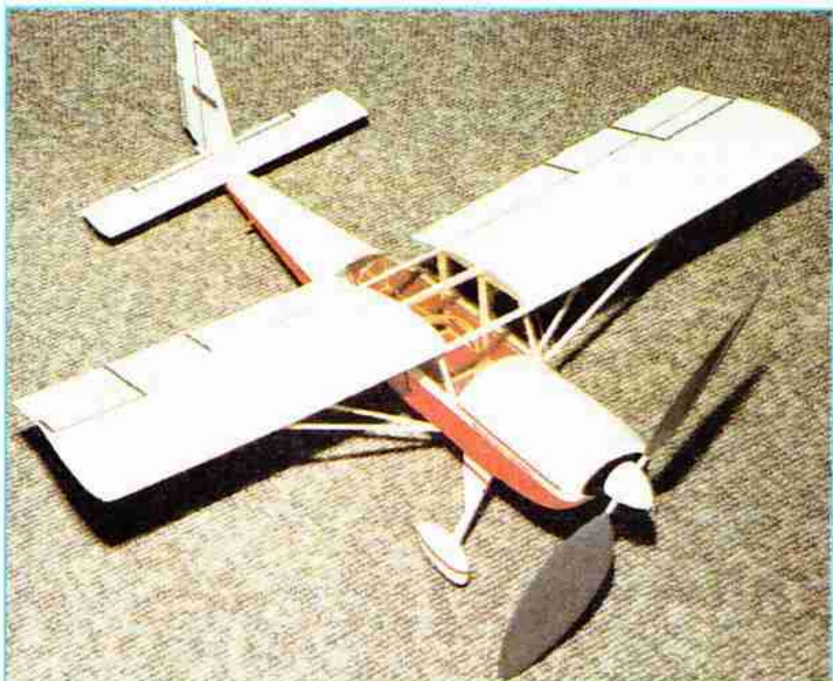
„Oříšek“ Robertson Skylark autora článku létá s dvoulistou vrtulí vlastní výroby (průměr 160 mm) stabilně přes 80 s.
