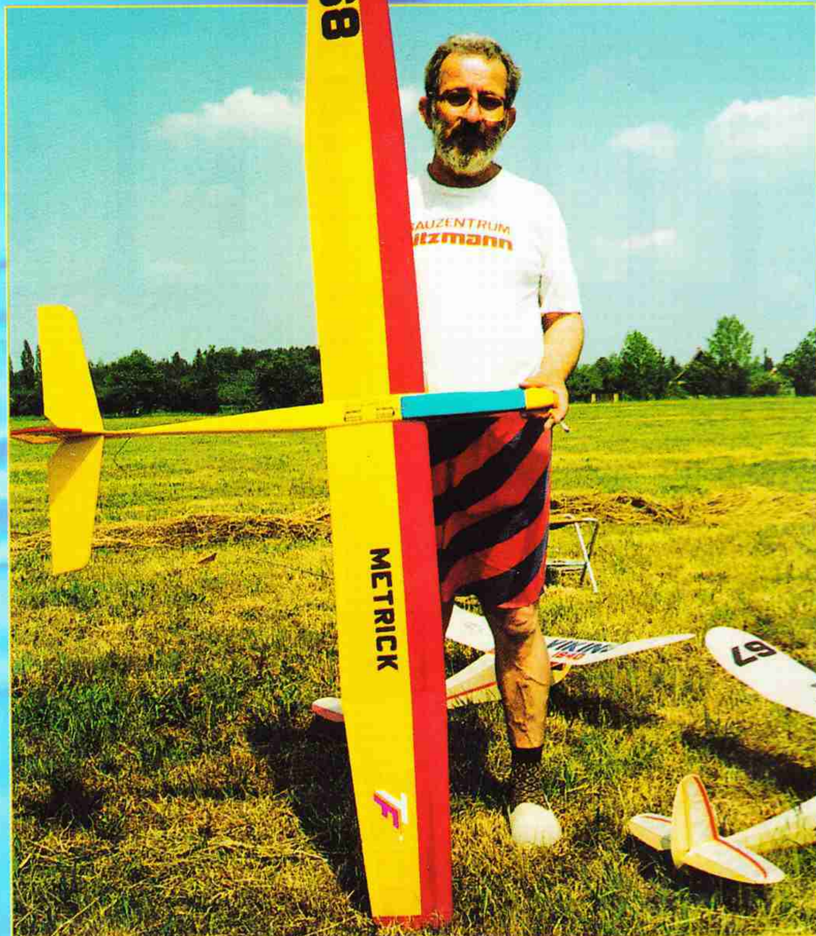
Dvoumetrovka Metrick z americké stavebnice fy Top Flite má podobně příjemné letové vlastnosti jako graupnerovo Amigo. Díky modernějšímu profilu E 205 je však dynamičtější. Na snímku J. Vaníček, SAM Plzeň.
