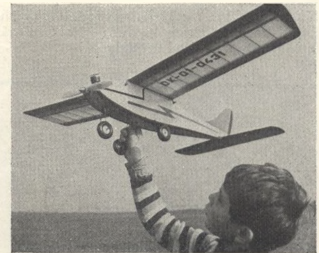
PLUTO - jednopovelový RC model na soupravu Gama a motor 1 cm 3 , rozpětí 1000 mm, celobalsový. Číslo 3 (s) Cena 5,50 Kčs
