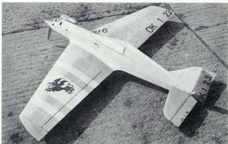
Model Petra Petrouška z Prahy pro závody kolem pylonů má rozpětí 1450 mm, délku 1000 mm a vzletovou hmotnost 2200 g. Motor je upravený OS MAX 40 FSR, RC souprava Kraft
