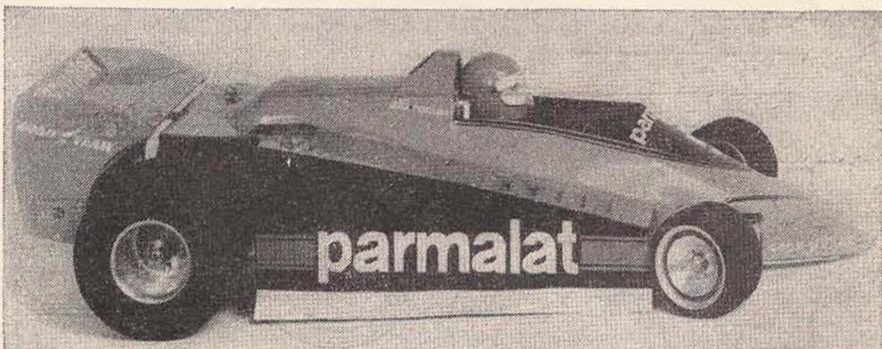
Zadní část modelu s pohonnou jednotkou a diferenciálem je připojena kyvně a odpružena jako celek. Přední náprava má nezávisle zavěšená kola na trojúhelníkových ramenech ▼
