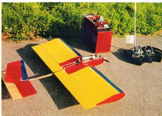
▲ Oldřich Vitásek z LMK Holíč si upravil plánek modelu Tadpole v Modeláři pro motor MVVS 3,5 GFR. Jeho „mini Tadpole“ má hmotnost 1300 g, křídélka jsou ovládána klasicky jedním servem, další tři serva ovládají výškovku, otáčky motoru i směrovku
