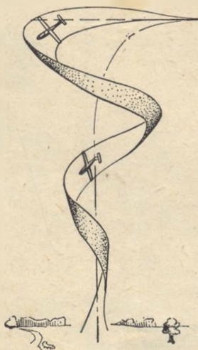
Obr. 10. Přechod modelu do spirály při spirální nestabilitě.
