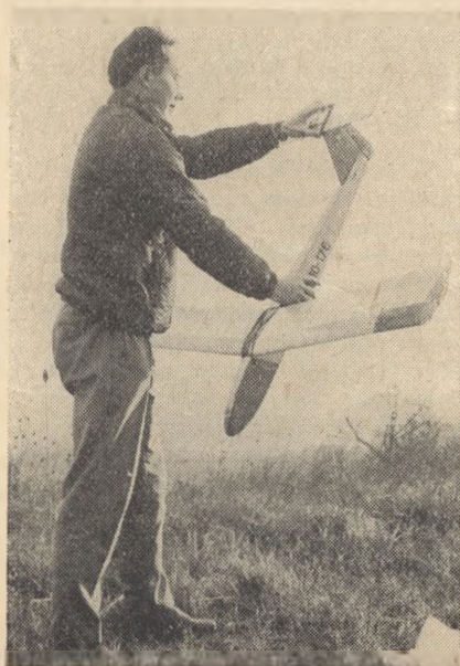
Obr. 4. V přímočarém ustáleném letu je vztlak roven váze modelu. V ustálené zatáčce musí být vztlak tím větší, čím větší je náklon. Se vzrůstajícím náklonem roste i plošné zatížení křídla a tím i klesavost modelu v zatáčce
