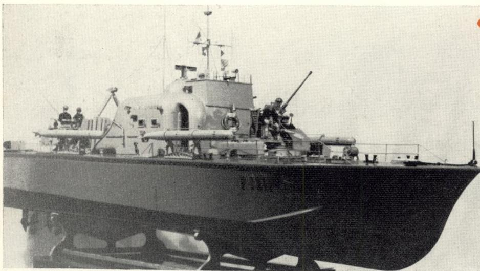
RC maketa torpédového člunu Brave Borderer mistra ČSSR ve třídě F2b, Karla Hocka z MK Vsetín. Měřítka 1 : 25, elektromotor Wartburg, RC souprava amatérská, 5 povelů
