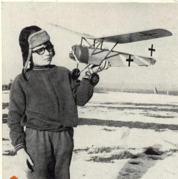
RC polomaketu Fokker D VIII postavil A. Kula z Mistrovic u Karviné, „pilotuje“ ji syn Andrej. Model o rozpětí 1050 mm má plošné zatížení 42 g/dm<sup>2</sup>. Motor je Fok 1,5 cm<sup>3</sup>, řízena jen směrovka
