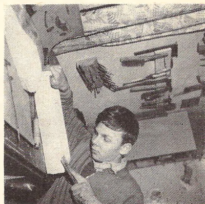
Vojín Radek Mitáš vyrábí formu na laminátovou karosérii RC automobilu na motor MVVS 2,5 cm 3 a amatérskou proporcionální soupravu
