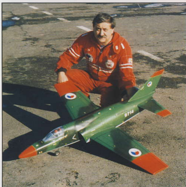
▲ Podle monografie, ale s vlastní konstrukcí postavili Ivo a Bronislav Růžičkovi z Přerova tuto polomaketu Fi - 156 STORCH. Model řízený RC soupravou PRO-MIX má rozpětí 3,8 m, hmotnost 15 kg, poháněn je benzínovým motorem o objemu 80 cm 3 .
