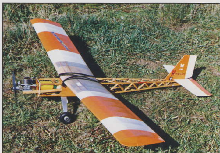
▲ Školní RC model HERKULES jehož majitelem je Alexander Komárnický z Kežmaroku má trup zhotovený z tuzemského materiálu o délce 1100 mm, rozpětí 1300 - 1700 mm (podle křídla, které je v danou dobu k dispozici) a motor 3,5 cm 3 . Doposud nalétal 70 hodin s patřičným počtem vzletů a přistání, které vždy nebyly velmi měkké.
