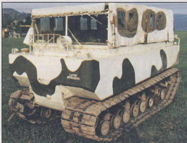
M29 ze sbírky Petra Šimka. Vozidlo na snímcích je v zimní kamufláži (barva khaki v kombinaci s bílou), bez ochranných krytů nad pásy. Na pravém pásu je vidět tluhářský stahovák, neboť pás je poškozen po „divoké“ jízdě.
