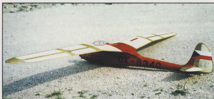
▲ Náš dlouholetý čtenář Franz Kubata z Ingolstadtu si pro své potěšení zhotovil polomaketu větroně RACEK 3 o rozpětí 2500 mm. Trup je z laminátu, křídlo ze Styroporu, potažené dýhou a zesílené uhlíkovými vlákny.
