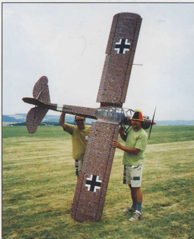
▲ Podle monografie, ale s vlastní konstrukcí postavili Ivo a Bronislav Růžičkovi z Přerova tuto polomaketu Fi - 156 STORCH. Model řízený RC soupravou PRO-MIX má rozpětí 3,8 m, hmotnost 15 kg, poháněn je benzínovým motorem o objemu 80 cm 3 .
