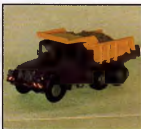
Z tohoto pohledu je dobře patrný zkrácený podvozek dampru Tatra (na snímku s nákladem písku).
