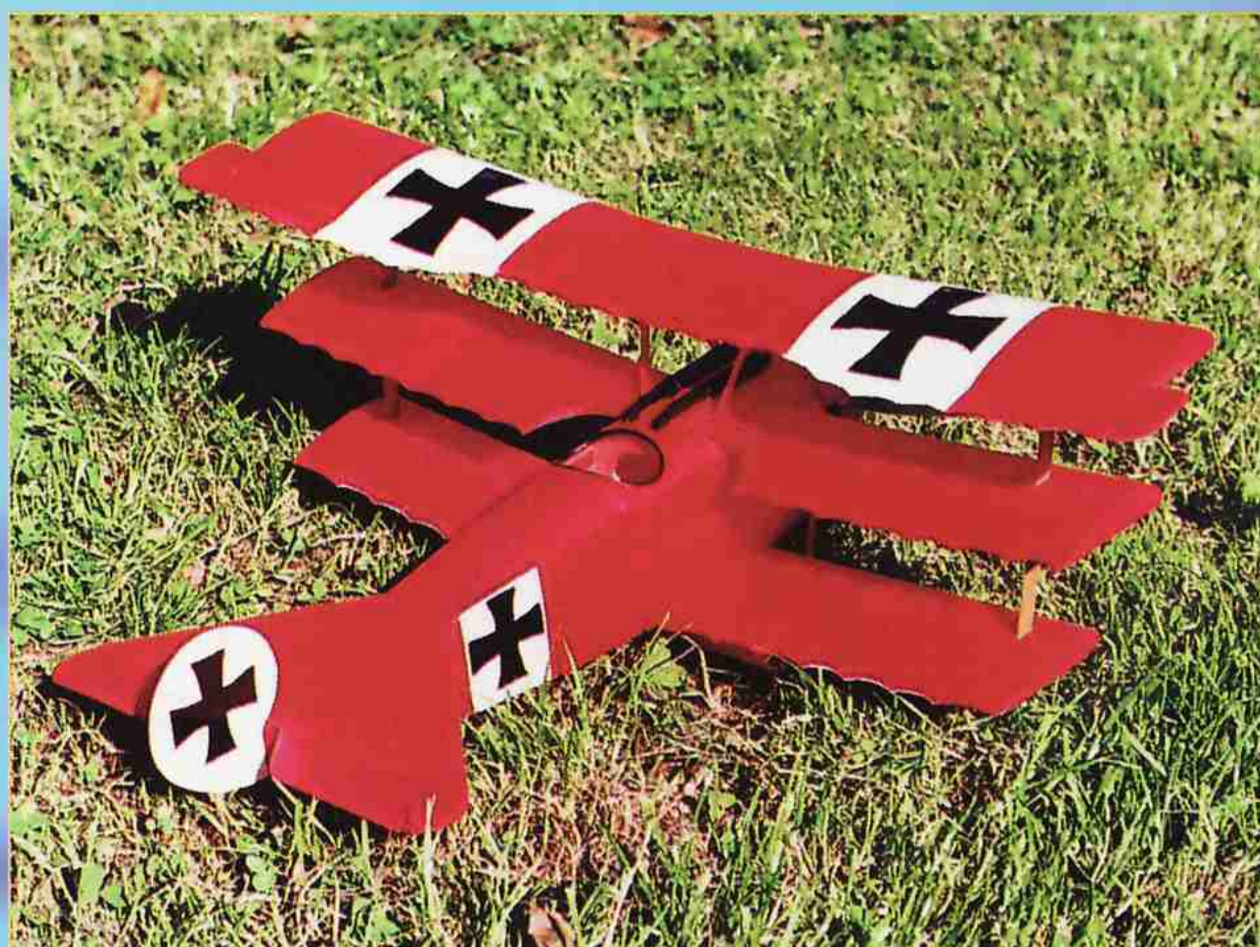
Maketa trojplášňáku Fokker Dr. I postavená podle plánu Z. Rašky. Rozpětí 560 mm, délka 433 mm, hmotnost 100 g, Motor Modela CO2S, délka letu 60 až 90 s. Postavil Jaroslav Kouba z Lázní Bělohrad.
