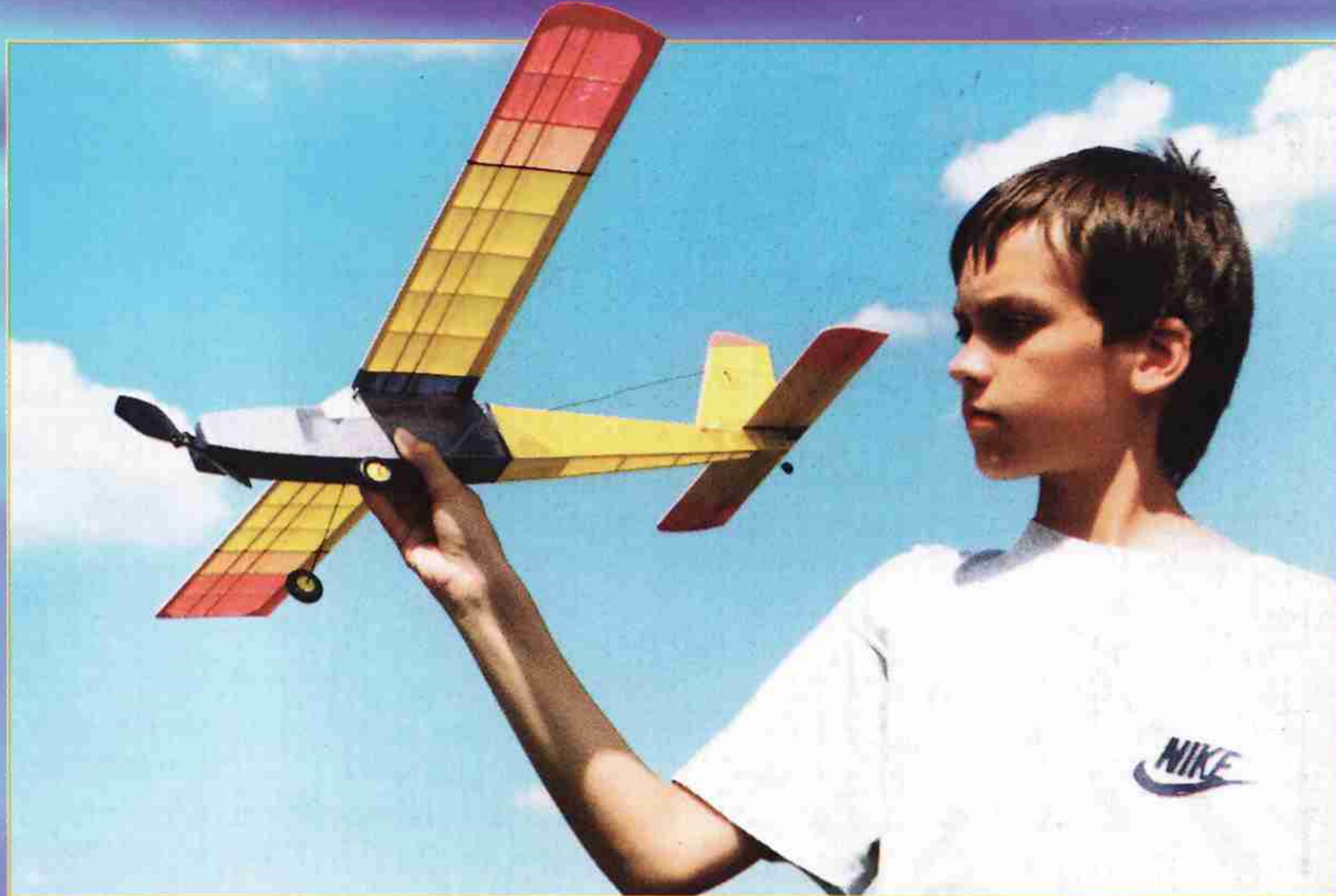
Malý elektrolet Rajka poháněný jednotkou TP 03 s osmičlánkovým akumulátorem 110 mAh si postavil 13letý Ondřej Plaček z Prahy. Rozpětí modelu 735 mm, délka 615 mm, hmotnost 195 g, celková plocha 8,5 dm 2 . Je použit přijímač REX 4 micro, serva o hmotnosti 10 g jsou typu Jamara Super Micro
