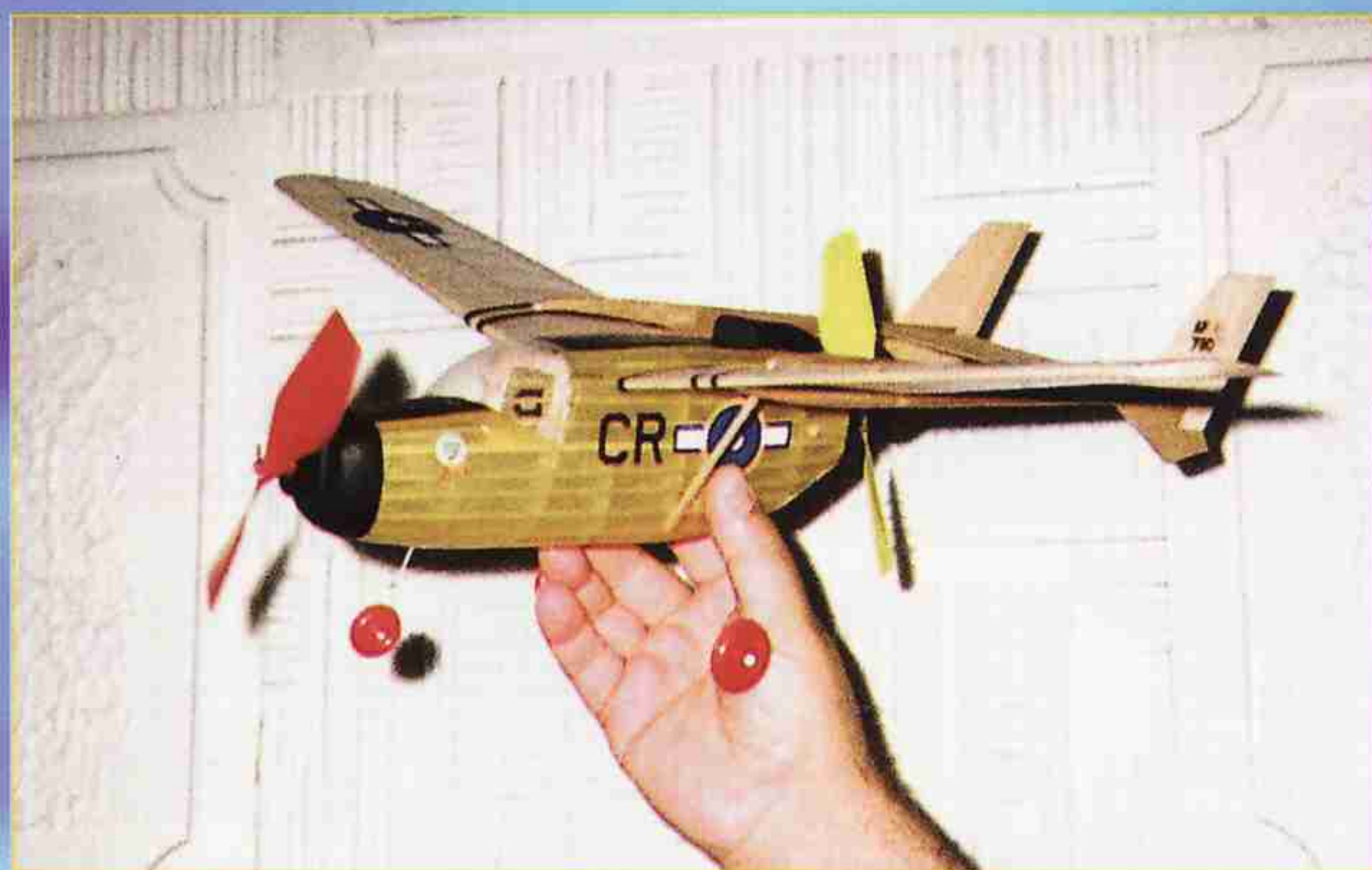
Dvoumotorová Cessna Super Skymaster (konstrukce Z. Raška). Rozpětí 560 mm, délka 435 mm, hmotnost 35 g. Dvě vrtule (tažnou a tlačnou) o průměru 145 mm pohánějí gumové nitě (2 ks 1x6). Model postavil Milan Lev z Rakovníka.
