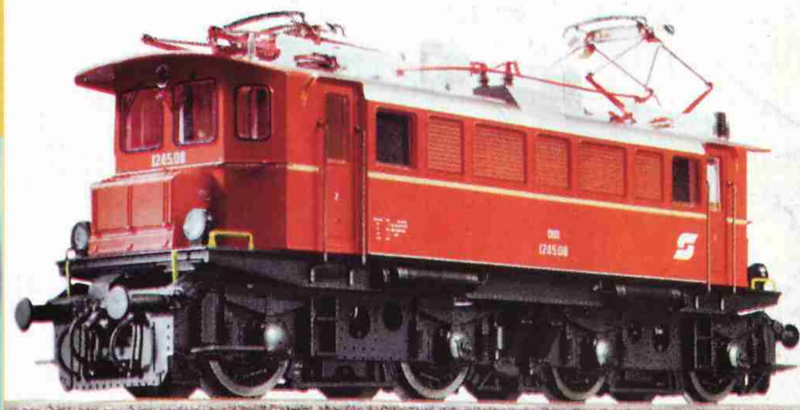
Model elektrické lokomotivy 1245-08 rakouských železnic ÖBB ve verzi „Seltzhal“ (epocha IIIb - 1955 až 1970). Model ve velikosti H0 (délka 147 mm) má kovové „šasi“, přenos pohonu od elektromotoru zajišťují dva kardanové hřídele. K přívodu proudu do motoru lze využít funkční pantograf. Jde o výrobek firmy Lima.
