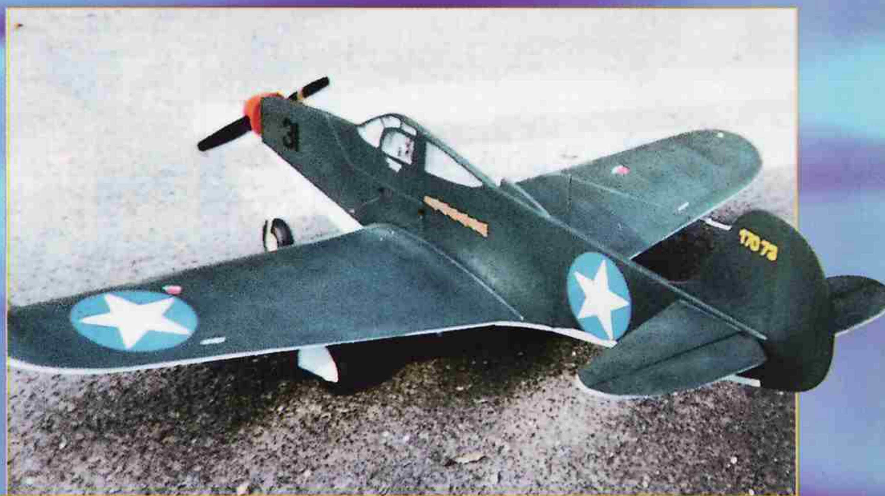
Upoutaný model stíhačky Bell 39 Aircobra postavili členové modelářského kroužku LMK Stříbro Mirek a Martin Urbanovi, pod vedením jejich staršího kolegy Milana Jůdy z Chodové Plané. Model (postavený podle plánu z Modeláře) z překližky a balzy má rozpětí 930 mm, poháněn je motorem Modela 2 cm 3 .
