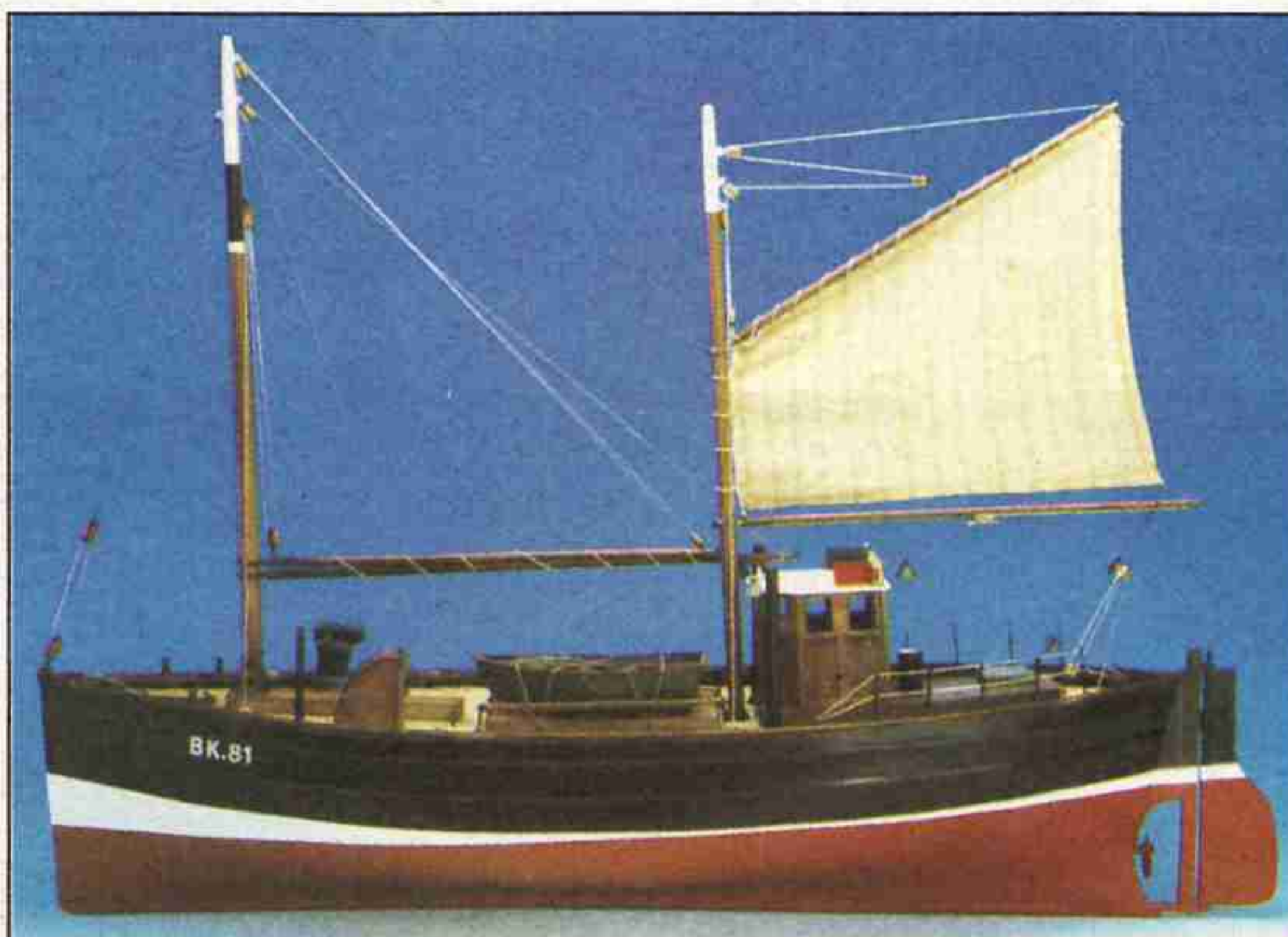
Malý skotský rybářský kutr AMARANTH BK.81 dodává jako stavebnici v měřítku 1:40 (délka 600 mm, šířka 170 mm, výška 420 mm) německá firma Krick. Třílístý lodní šroub detailně zpracovaného plovoucího modelu je poháněn elektromotorem.
