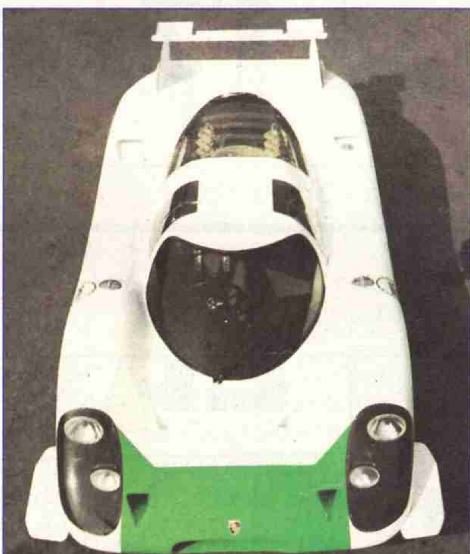
Výjimka z pravidla, čtyřapůllitrové Porsche 917 s dvaktiválcovým motorem typu Boxer (objem 4494 cm 3 ). Tyto vozy o maximální rychlosti 320 km/h závodily v letech 1975 až 1977 mezi sportovními vozy „Skupina 4“. Jeho tehdejší „prodejní“ cena byla 120 000 DM.
