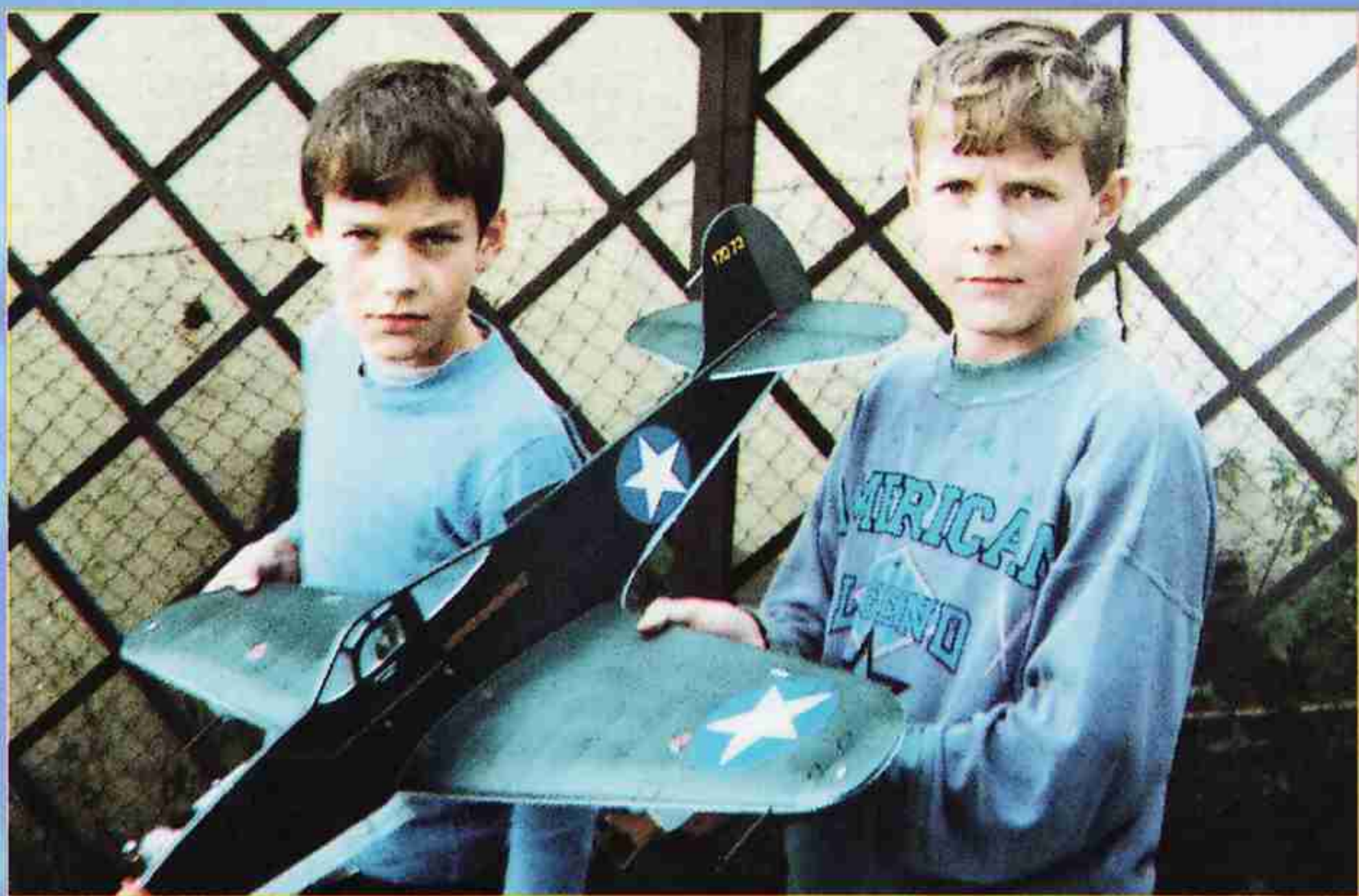
Upoutaný model stíhačky Bell 39 Aircobra postavili členové modelářského kroužku LMK Stříbro Mirek a Martin Urbanovi, pod vedením jejich staršího kolegy Milana Jůdy z Chodové Plané. Model (postavený podle plánu z Modeláře) z překližky a balzy má rozpětí 930 mm, poháněn je motorem Modela 2 cm 3 .
