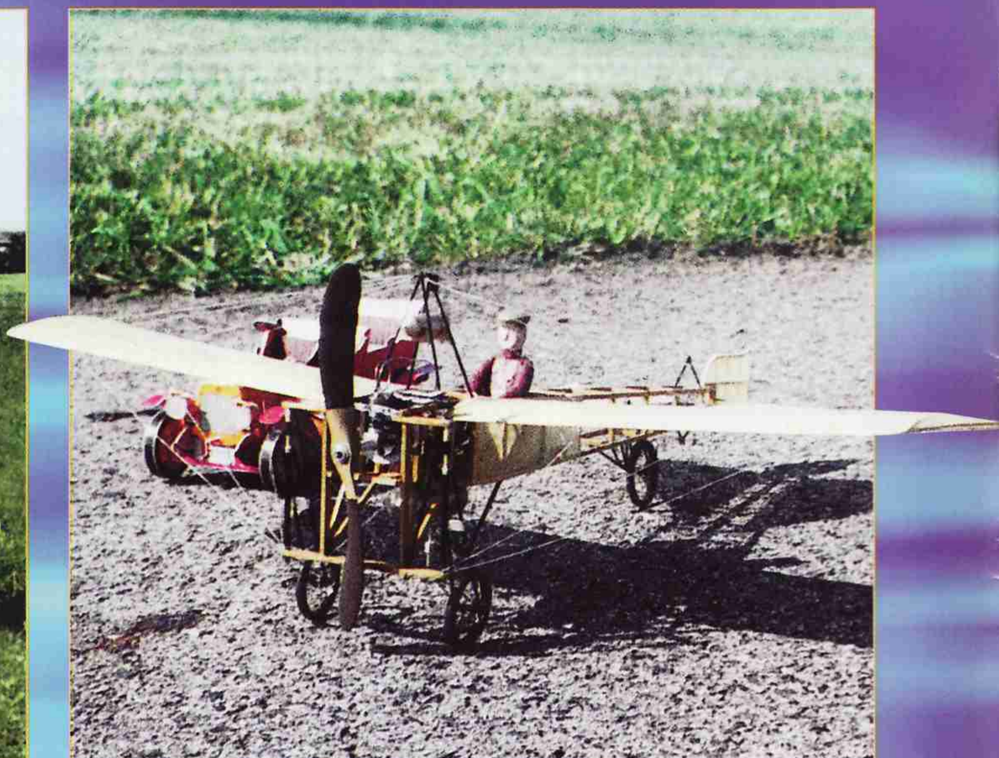
Model na snímku představuje letoun ing. J. Kašpara systému Bleriot. Model je poměrně věrnou kopií stroje, který je umístěn v „Dopravní hale“ Národního technického muzea. Rozpětí modelu 400 mm, hmotnost 21 g, motor Gašparín G-24. Postavil Jan Vrba, Kladno.
