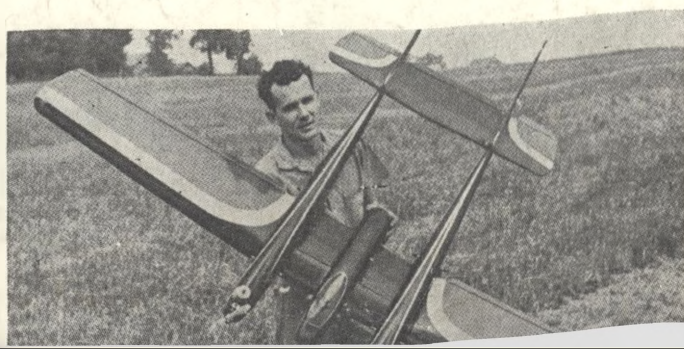
Jeden z nových amerických dvoumotorových modelů. Rog Downing použil dvou trupů a uprostřed nastaveného křídla známého modelu Taurus
