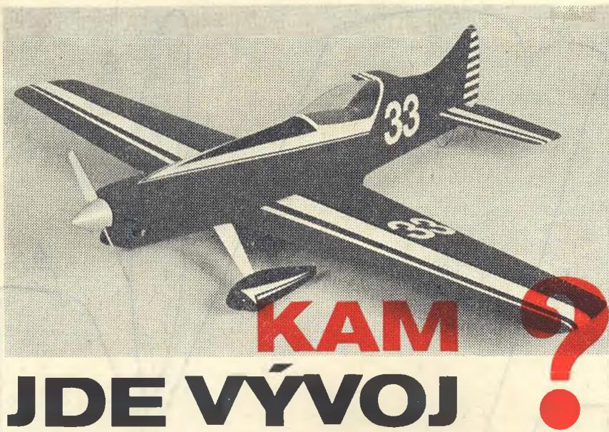
Model Arriba od firmy Rowan je výlučně pro závod okolo pylonu. Rozpětí 1250 mm, délka 980 mm, motor 6,5 cm³, vzletová váha asi 2200 g
