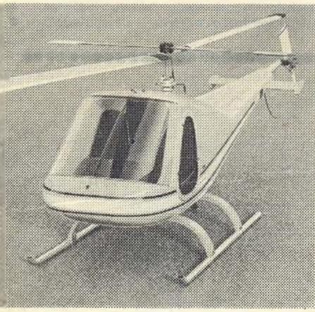
Vrtulník DS 22 vyráběný firmou Hegi má průměr rotoru 1560 mm, vzletovou váhu 4500 g a pohání jej motor 10 cm<sup>3</sup>; řízený je 4 funkce
