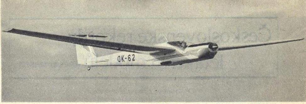
Výhodou výcvikového motorového větroně je především to, že odstraňuje potřebu navijáku i vlečného letadla, neboť je schopen samy odstartovat a dosahovat výšky potřebné k nácviku jakéhokoli letového výcvikového prvku. Omezuje na minimum potřebu transportních vozů a automobilů, neboť v kritické fázi letu je možno spustit motor. Tím je také omezeno riziko havárie při přistání v terénu, které tvoří dosud podstatnou část nehod při bezmotorovém létání.
