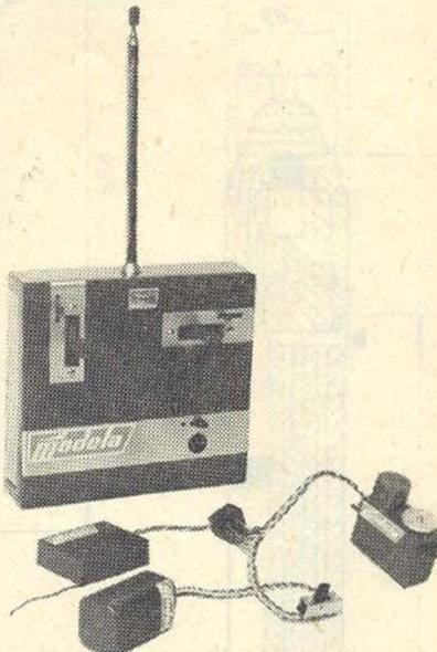
Pohled na jeden z prototypů soupravy Modelá s jedním servem. Vlevo vpředu je zdroj, nad ním přijímač, vpravo servo. V pozadí vysílač
