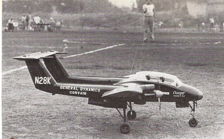
Upoutanou maketu „Charger“ postavil P. Lejčik z Děčína. Má rozpětí 1110 mm, délku 1420 mm, hmotnost 4500 g a poháněna je dvěma motory TONO 5,6 RC
