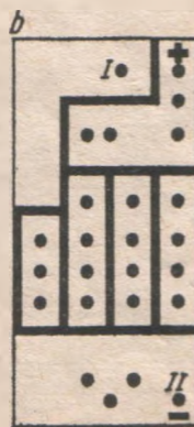
OBR. 3. Deska plošného spoje popisovaného doplňku vysílače (1:1, podle ze strany fólie). K poli I je připojen kladný pól napájecí baterie, pole II je připojeno na záporný pól baterie
