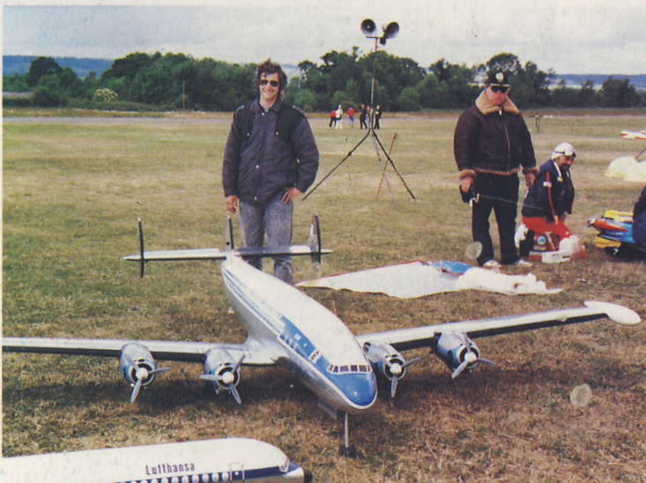
▼ Wolfgang Köhler zo SRN predvádza so svojou maketou Super Constellation aj lety na chrbte. Stavba modelu v mierke 1 : 10, poháňaného štyrmi motory Webra 10 cm 3 , trvala tri roky
