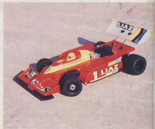
▲ Povrchová úprava napovídá, že jde o model RC V1 ing. A. Jirásků z Mnichova Hradiště. Podvozek CUMIS 4x4 má dvoustupňovou převodovku, zadní nápravu se dvěma tlumiči s vinutými pružinami a rychloupínáním kol, přední nápravu s volnoběžkami. Hmotnost modelu, poháněného motorem Mondial Pro 88, je 2,75 kg
