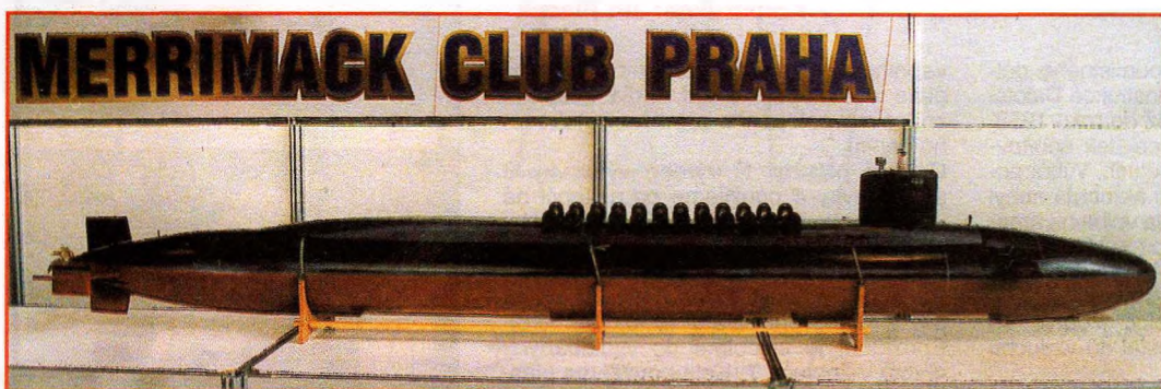
Model americké ponorky U.S.S. Georgia SSBN-729 třídy Ohio v měřítku 1 : 72 (délka 2,4 m). Plně funkční RC model je schopen plavby i jízdy pod hladinou, na palubě jsou makety odpalovacího zařízení pro 24 raket třídy Trident. Čtrnáct těchto zařízení je funkčních a může odpalovat modely raket i pod hladinou jako skutečná ponorka. Zhotovil V. Starý, Merrimack Club Praha.
