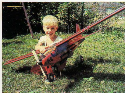
Variace na bázi leteckého RC modelu Chéri 2 (viz skvělý test v Modeláři 4/76). Hornoplošník s tříkolým podvozkem má křídlo z polystyrenu (rozpětí 1400 mm), motor MVVS o zdvihovém objemu 2,5 cm 3 má podvěšený tlumič.
