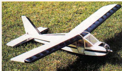
Malý RC model pojmenovaný BROUK je vlastní konstrukcí Michala Šnejdara ze Štěk-ně. Model o rozpětí jen 1000 mm má letovou hmotnost 650 g, k pohonu slouží motor COX Dragonfly.049 (0,8 cm 3 ) vybavený „akrobatickou“ nádrží. Výškovku, směrovku a otáčky motoru ovládají mikroserva HS.80. Přechody motoru z nízkých otáček do vysokých jsou rychlé díky otočnému tlumiči hluku (sice poměrně staré řešení, ale funguje bezvadně). Jde o model rekreačního charakteru, dokáže létat i velmi pomalu, bez potíží zvládne i základní akrobatické prvky, úpinou lahůdkou je vývrtka.
