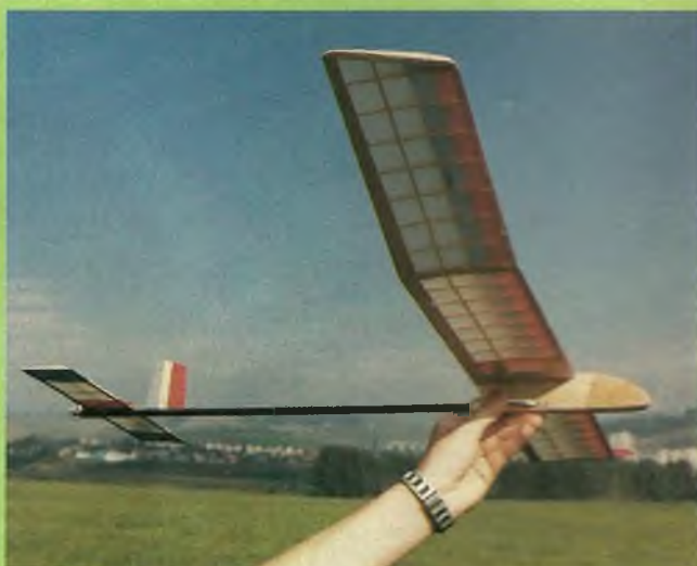
Martin Divok ze Spišské Nové Vsi si podle plánu Ing. Jána Mydla postavil soutěžní kluzák kategorie A3 Mimi II. Model o rozpětí 1010 mm a délce 640 mm je celobalzový, potažený Mode-spanem. Trup tvoří uhlíková trubka o průměru 5 mm. Model létá s bočním háčkem
