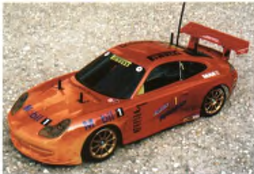
Třináctiletý Patrik Maruščák z Brezna si postavil ze stavebnice Tamiya Porsche 911 GT-3. Pohání jej motor Stock; regulátor je LRP V7, zdroj Sanyo 3300 a RC souprava Futaba Megatech
