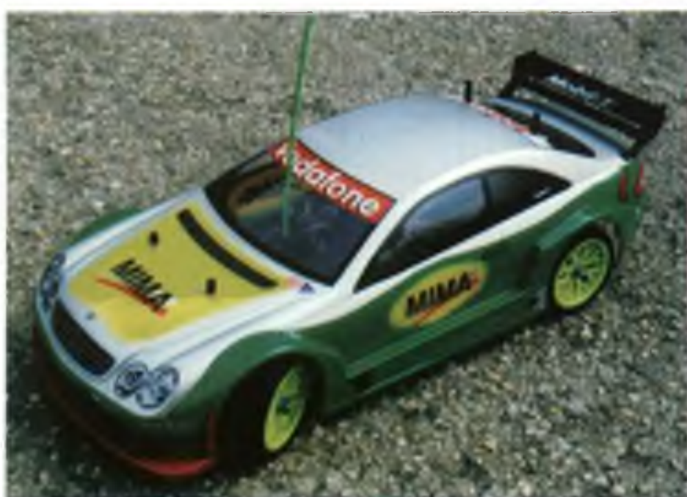
Milan Ježík z MK Mišiak Banská Bystrica soutěžil s modelem Mercedes CLK na podvozku Tamiya TA-04 (motor Stock, regulátor LRP V7, zdroj Hopf 3500, RC souprava Futaba Mechatech 3PJ)
