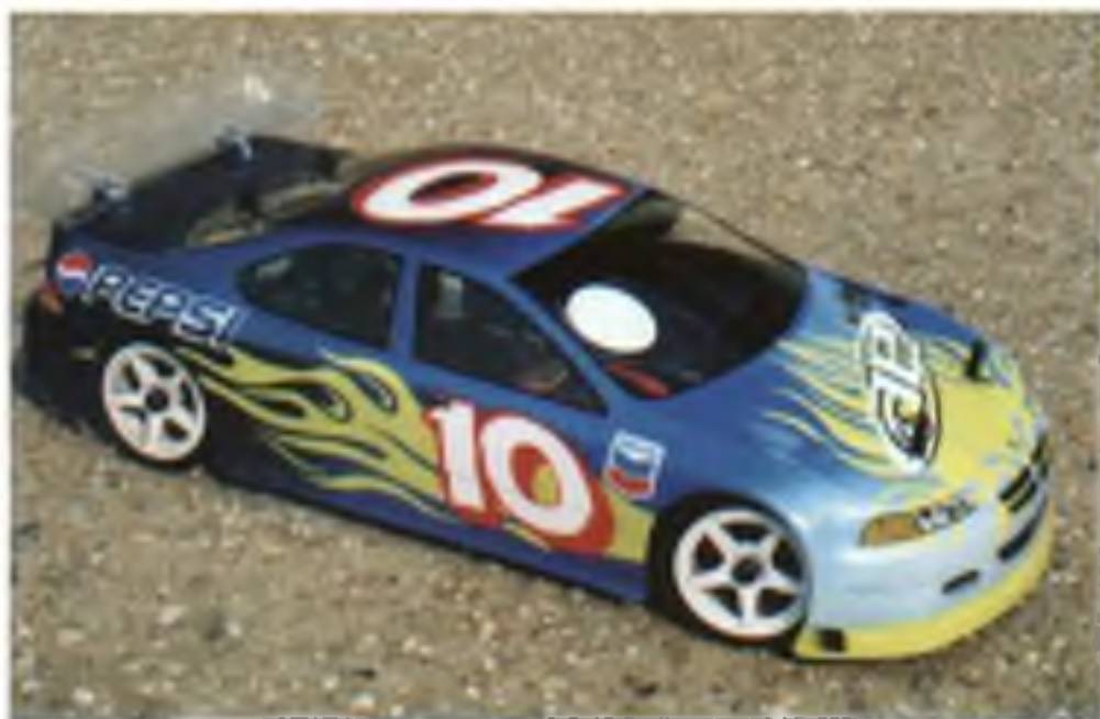
Člen bratislavského XXXL klubu Lubomír "Dudy" Dudák soutěžil s modelem Dodge Stratus na podvozku Asso TC-3. Model je osazen motorem Corally 17x2, regulátorem Rocket, zdrojem Sanyo 3300 a ovládán RC soupravou Ko-Propo
