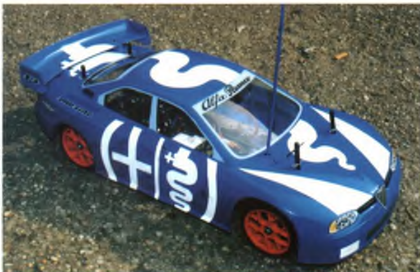
Alfu Romeo 156 si pro novou soutěžní sezónu postavil Albert Máté z Rimavskej Soboty (podvozek Yokomo YR, regulátor Graupner V8, motor Orlon 12x2, zdroj GM 2400 a RC souprava Graupner XR-3)
