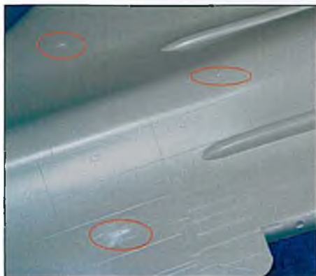
Na horní straně trupu jsou tři hroty se stopami nešetřného začíštění formy
