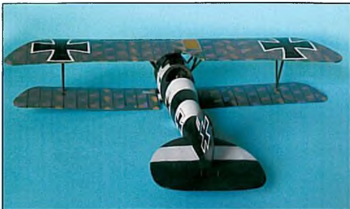
Usadenie horného krídla na vzpery bola pohoda, akurát treba dať pozor na celkovú geometriu
