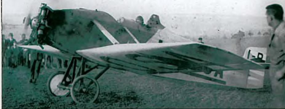
B.H.5 v pozdější době s motorem Walter a praporovými znaky. Levé kolo podvozku nemá plátěný potah
