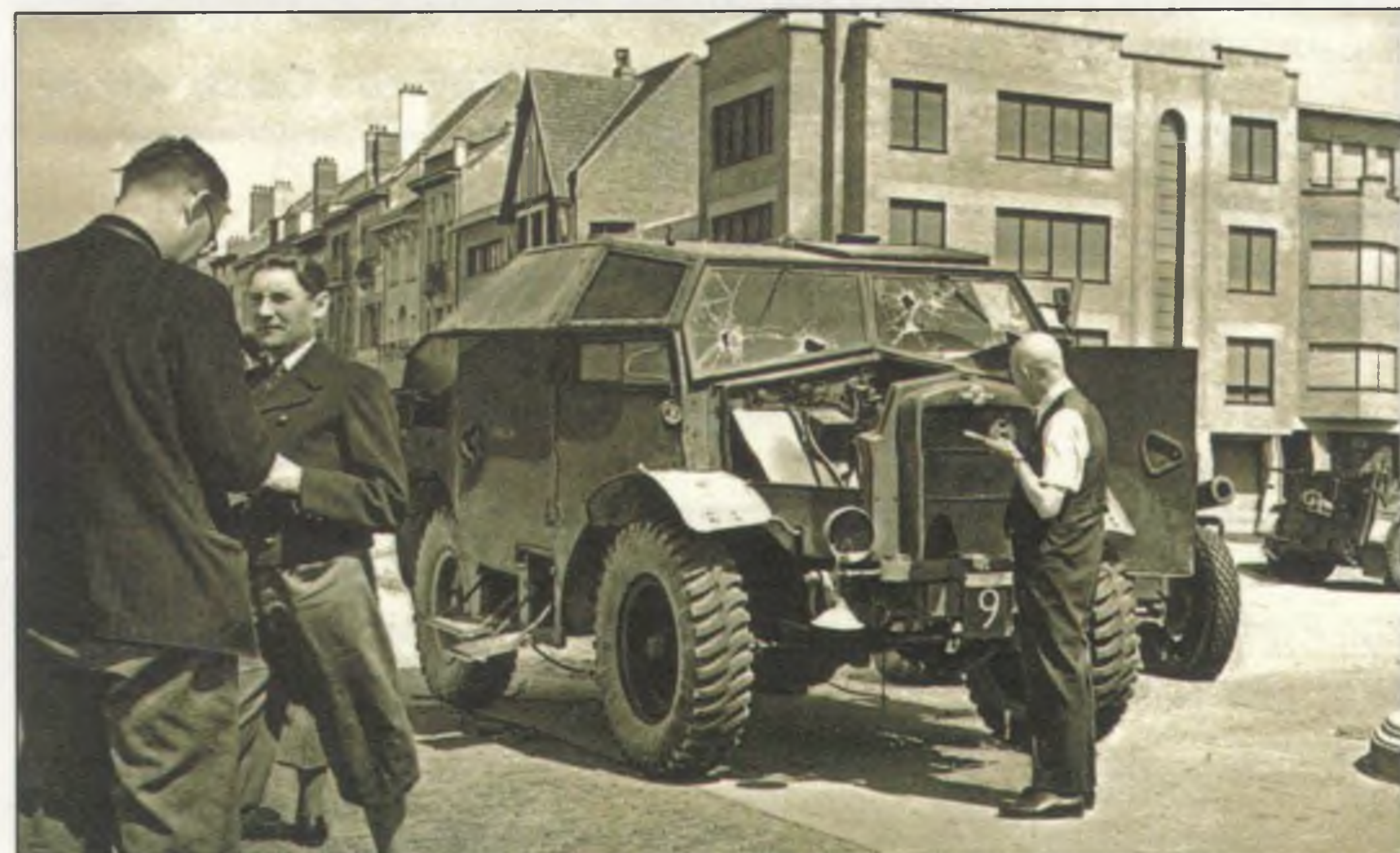
Quad gun tractor Britských expedičních sil opuštěný u Dunkerque se sejmutými kryty motorového prostoru ve standardním záprahu s muničním vozíkem a kanonem 25 pdr.
