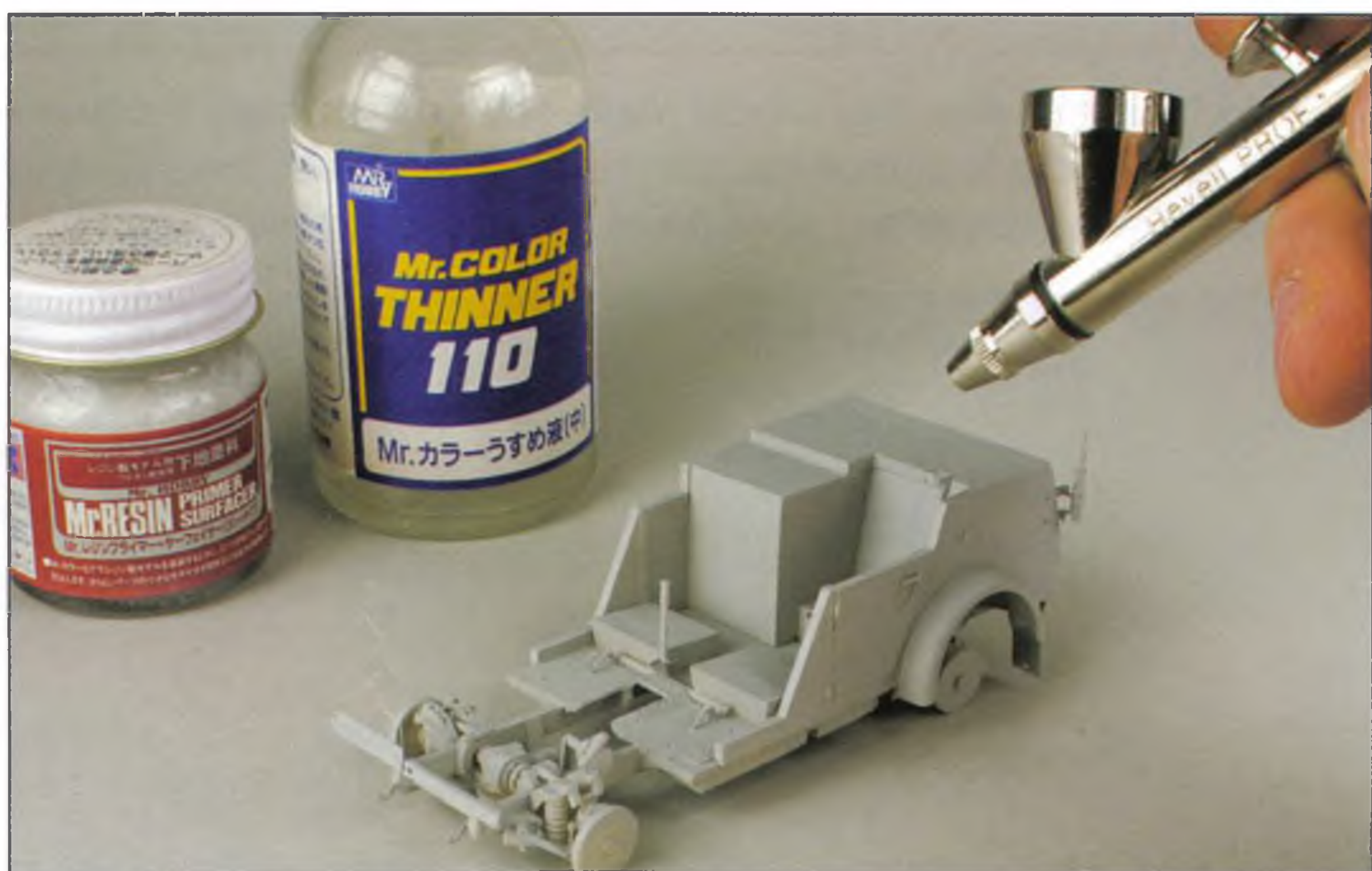
Ak chceme predísť olupovaniu farby z reziny, je potrebné celý model nastriekať prípravkom Gunze Mr. Resin Primer. Povrch je po jeho aplikácii trochu hrubý, oplatí sa ho preleštiť mokrým brúsnyim papierom hrúbky 2000
