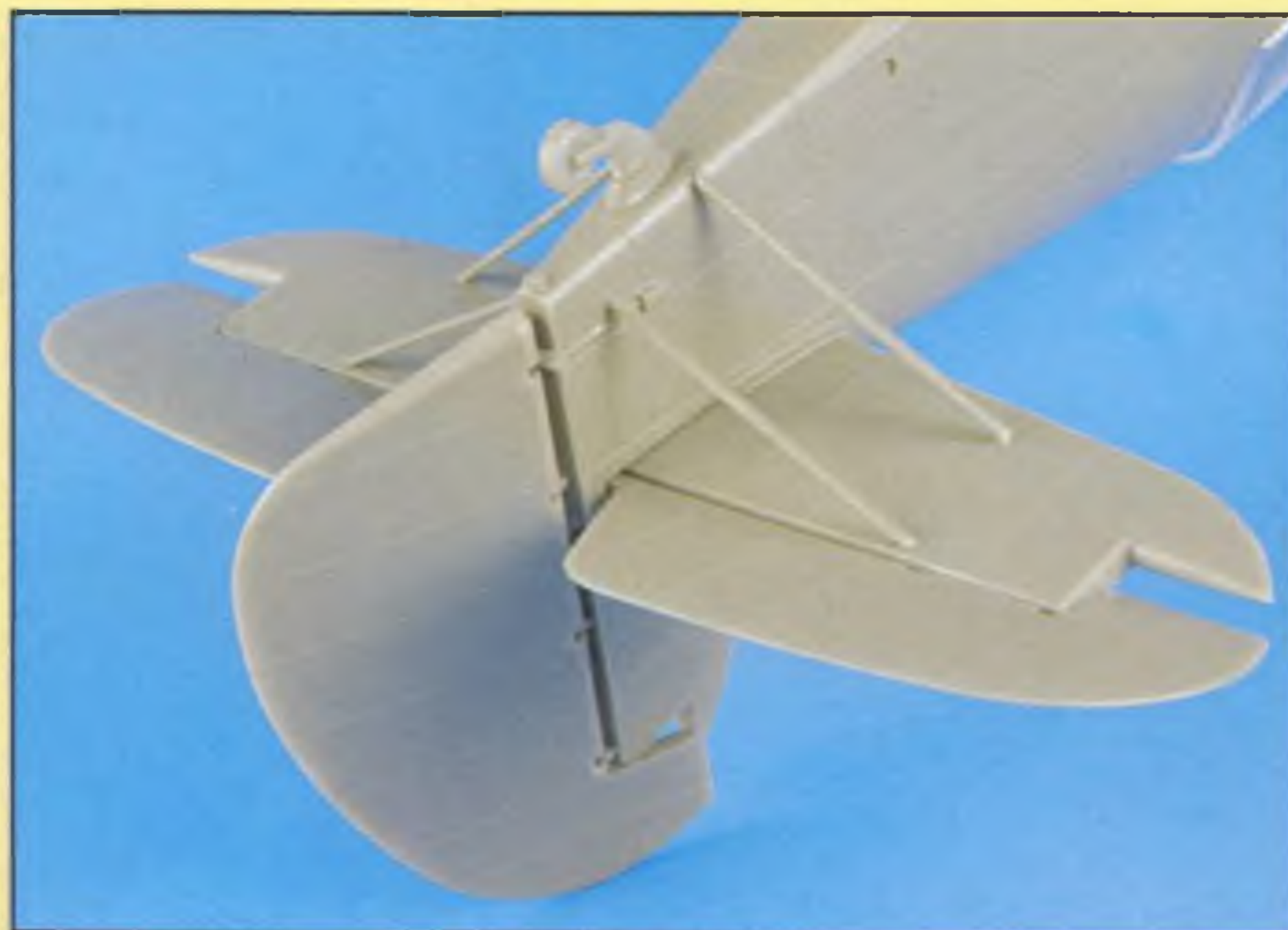
Stavebnica ponúka správne podľa verzií pre III. sériu pevnú ostruhu a pre IV. sériu ostruhové koliesko
