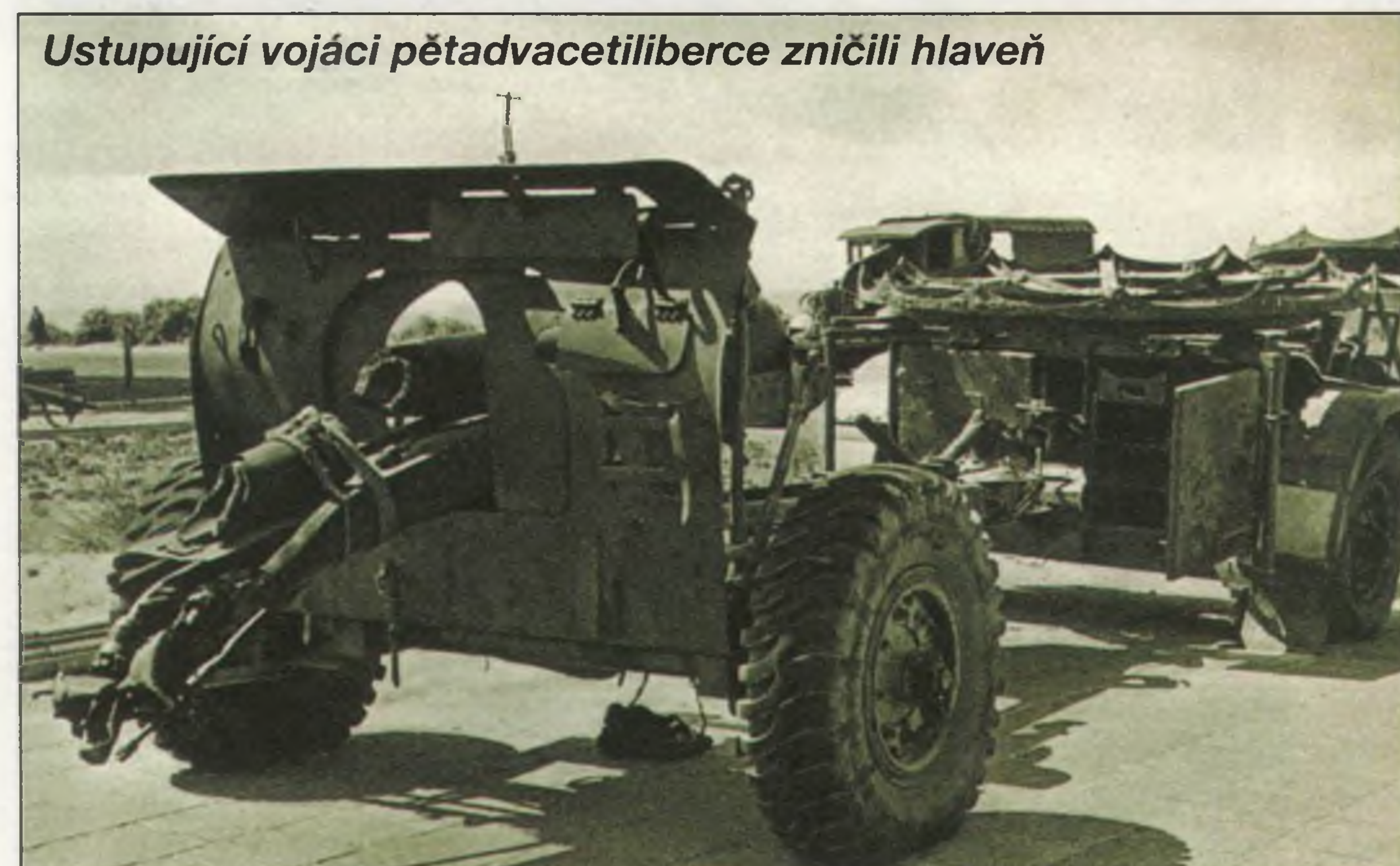
Quad gun tractor Britských expedičních sil opuštěný u Dunkerque se sejmutými kryty motorového prostoru ve standardním záprahu s muničním vozíkem a kanonem 25 pdr.
