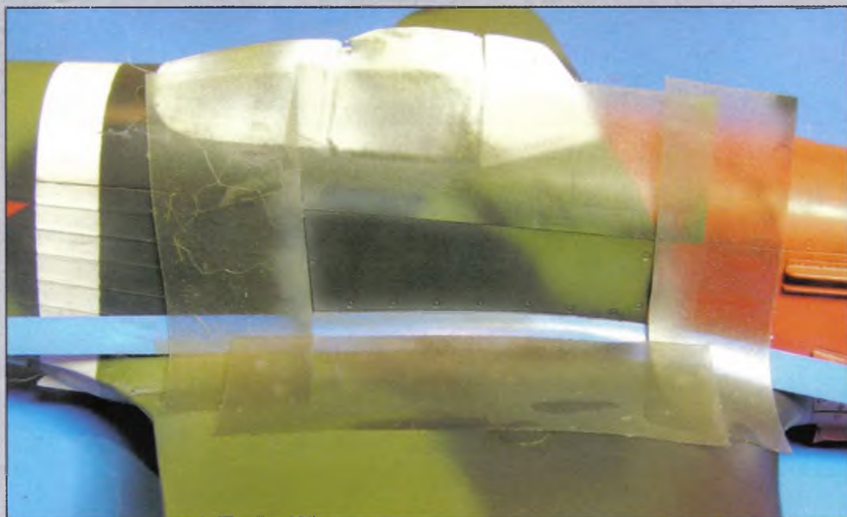
Stále se mi zdálo, že boční panely splývají s povrchem, proto jsem jejich hrany lehce přestříkl světle šedou
